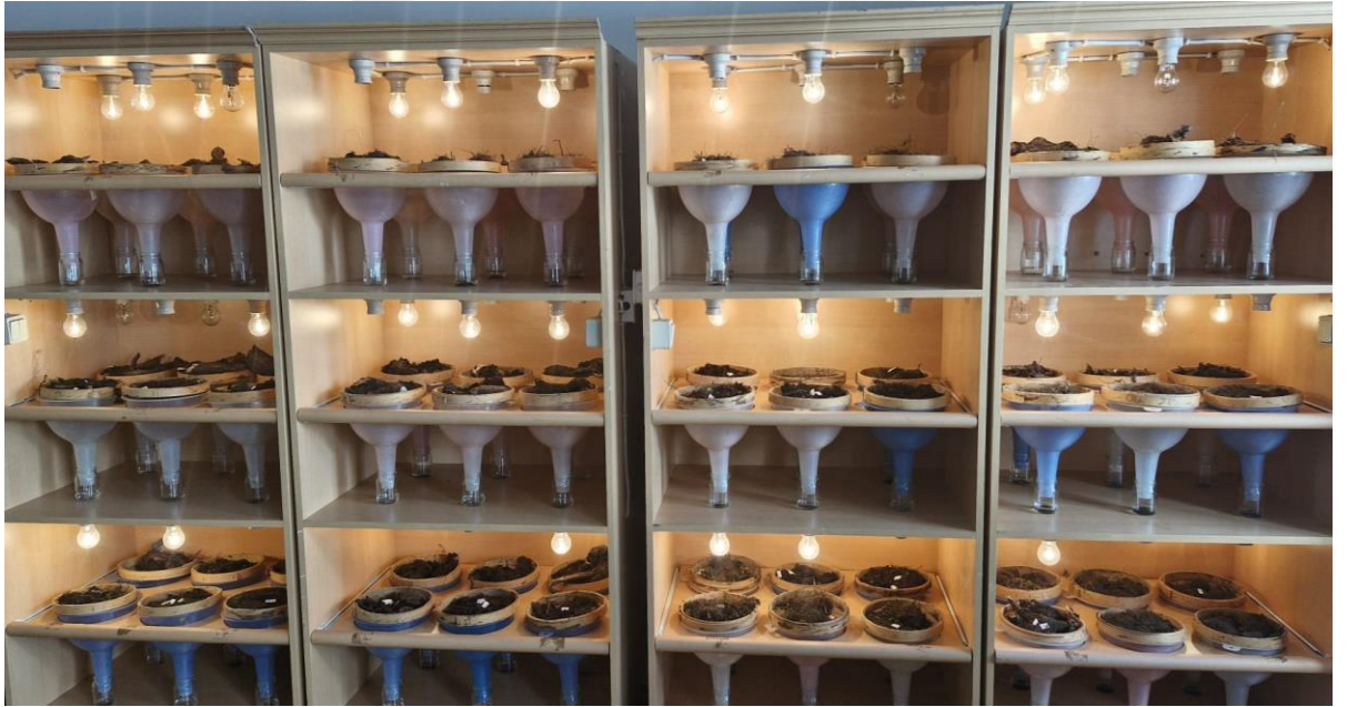
Şekil 3. Birleştirilmiş Berlese-Tullgren düzeneği
