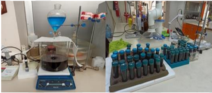
Şekil 28. Karayemiş örneklerinden CuONP’lerin sentez işlemi ve santrifüj tüpleri
