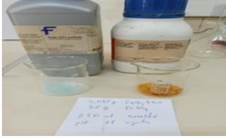
Şekil 15. FeSO 4 çözeltisinin hazırlanması
