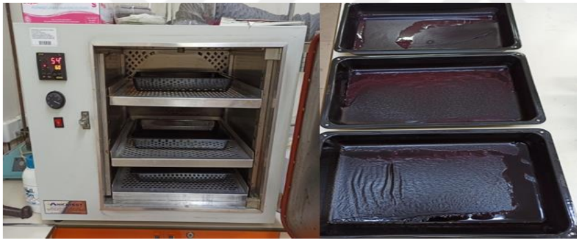
Şekil 11. Tepsilerde karayemiş ürünlerinin buharlaştırılması
