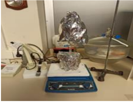
Şekil 24. Karayemiş örneklerinden AgONP'lerin sentez işlemi
