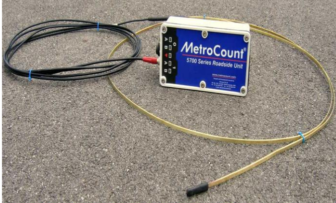
Şekil 2.4. Otomatik taşıt sınıflandırma sayımları yapan cihaz ve parçaları
