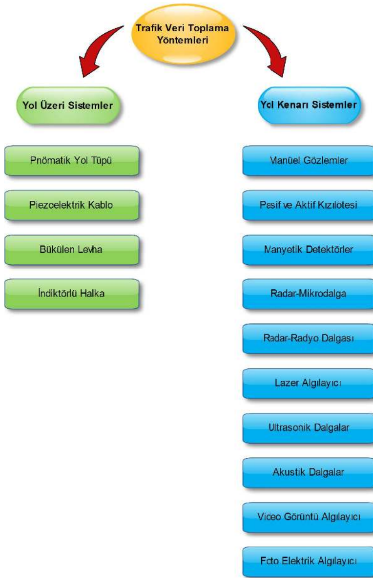
Şekil 2.1. Yol üzeri ve yol kenarı veri toplama cihazları
