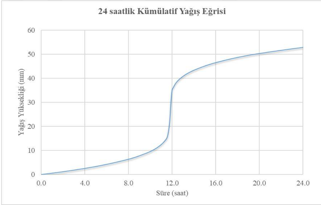
Şekil 3.28 Diyarbakır ili için SCS Type II kümülatif yağış eğrisi
