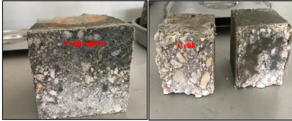
Şekil 5.9. Buz çözücü tuz deneyi (CDF) sonrası PP ve çelik lifli numuneler.
