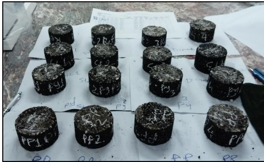
Şekil 4.18. Lif katkılı BSK’larla üretilen Marshall deneyi numuneleri.
