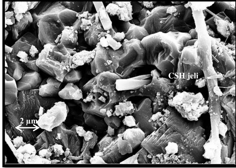
Şekil 5.31. PP1 numunesinin 10kx SEM analizi görünüşü.
