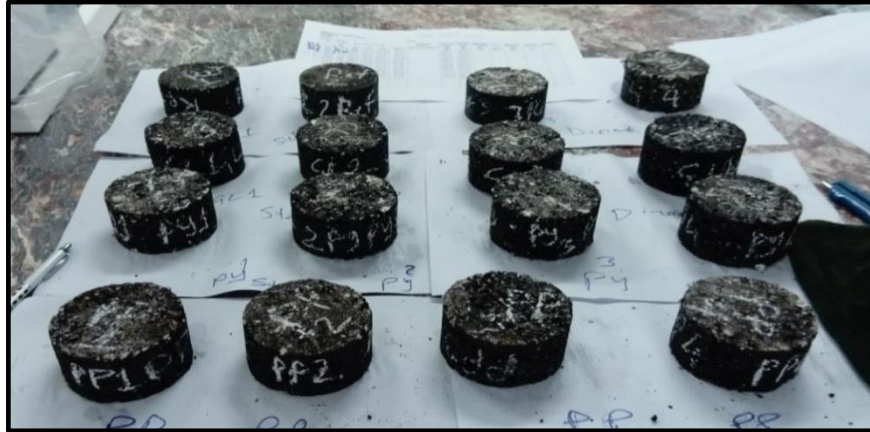
Şekil 5.12. Marshall deney numuneleri.
