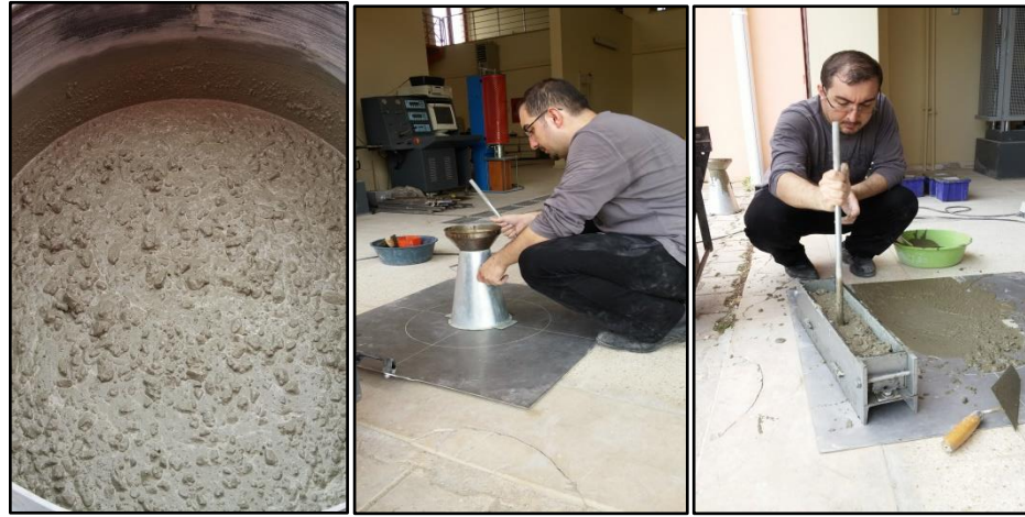
Şekil 4.2. Lifli beton karışımların hazırlanması.
