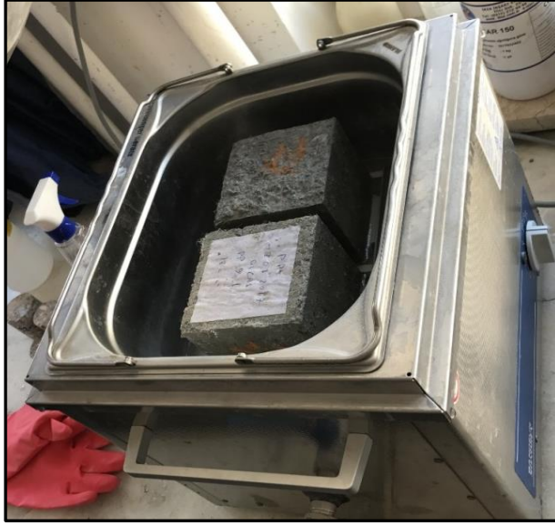
Şekil 4.13. CDF deneyinde numunelere ultrasonik banyo uygulanması.
