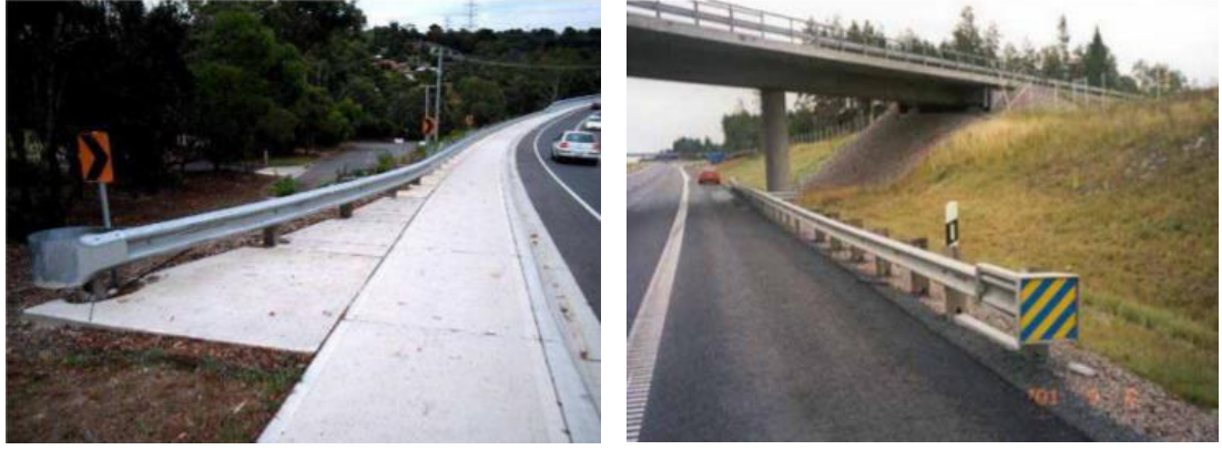
Şekil 4.7. Yatay olarak kaydırılmış bariyer bitişi ve teğet açılı bariyer bitişi (La Torre 2012).
