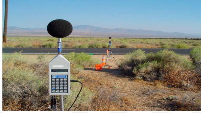
Şekil 13. Yol kenarı geçiş ölçüm cihazı (Rochat, 2012).
