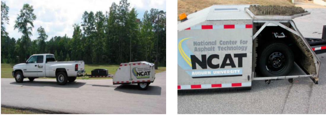
Şekil 15. Asfalt teknolojisi merkezi CPX treyler (Hanson vd, 2004)
