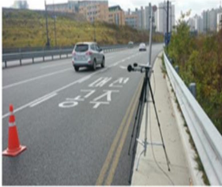
Şekil 34. Yol kenarındaki gürültü seviyesinin ölçülmesi (Yoo vd., 2020).
