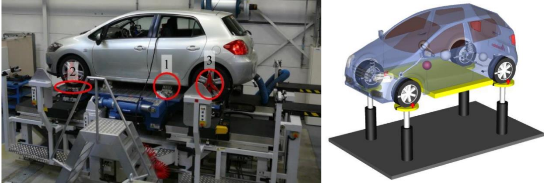
Şekil 2.7. Gerçek ve sanal kinematik & uyumluluk test platformu. Sundström ve ark (2016)
