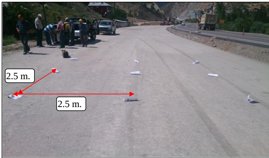
Şekil 4. Alttemel tabakası üzerinde 2,5 m aralıklarla testlerin yapılacağı noktalarının belirlenmesi ve LWD, nükleer yoğunluk test cihazlarının ve kum konisinin kurulması (Akpınar vd., 2015)
