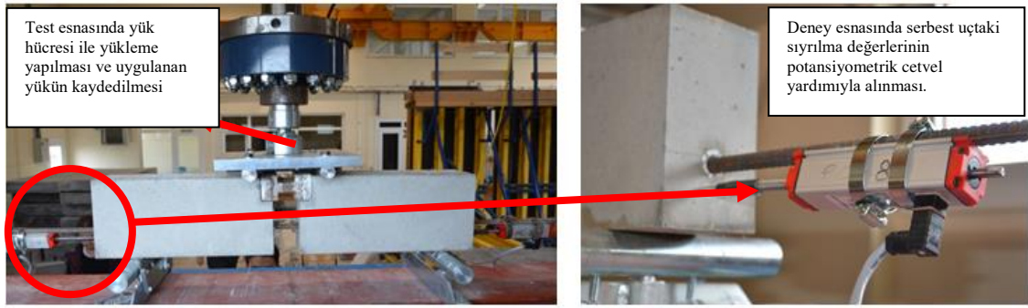
Şekil 5.15. Mafsallı kiriş deney düzeneği.
