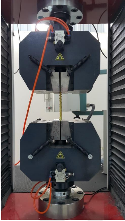
Şekil 5.10. Kompozit donatılarda çekme deneyinin uygulanışı.
