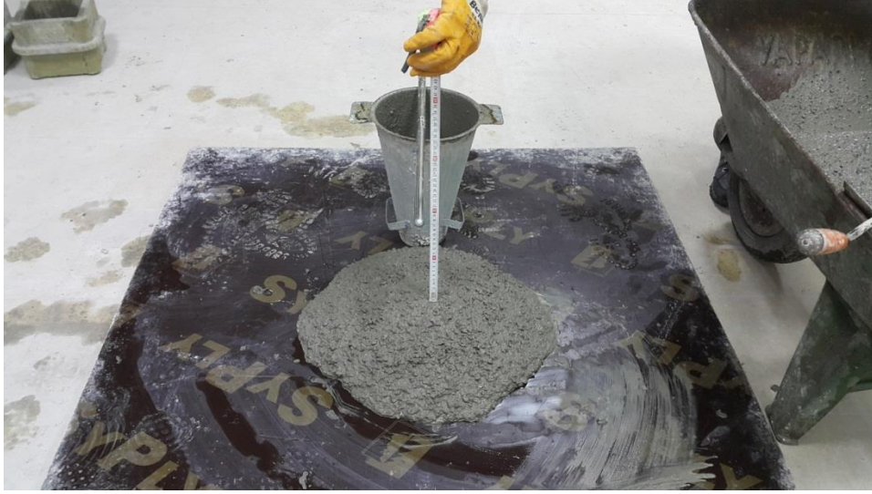
Şekil 5.8. S4 kıvam sınıfının kontrolü için slump deneyinin uygulanaşı.
