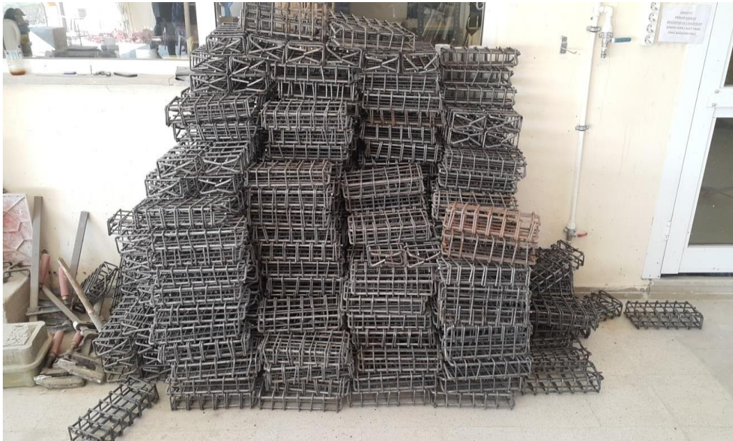
Şekil 5.7. Yaptırılan ve kiriş dökümüne hazır halde laboratuvara getirilen kesme donatıları.
