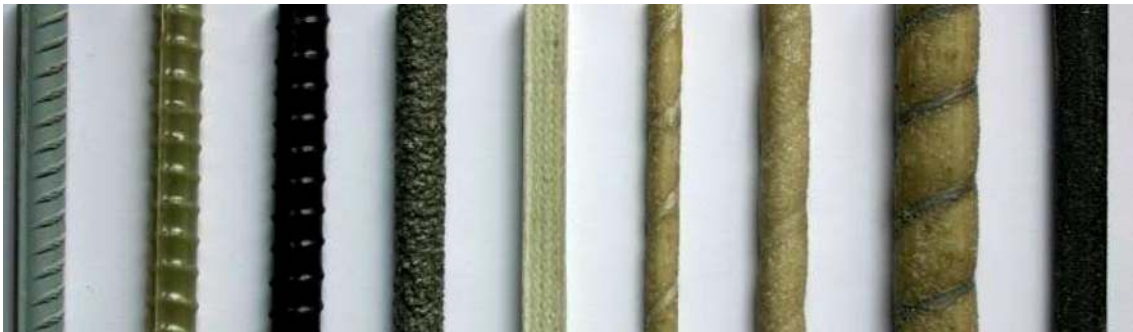
Şekil 2.9. Pultruziyon yöntemi ile üretilmiş bazı donatı çubukları [25].
