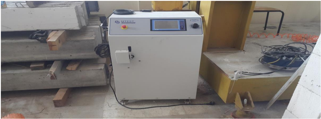
Şekil 5.16.Yüklemede kullanılan tam otomatik hidrolik güç ünitesi.
