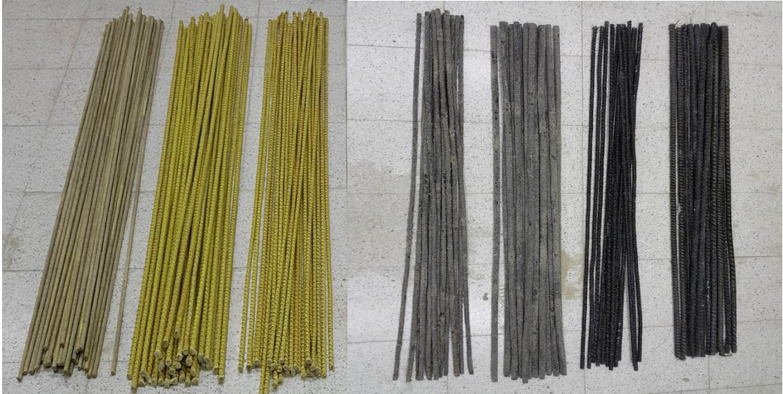
Şekil 5.4. Deneyisel çalışmada kullanılan kompozit donatılar.
