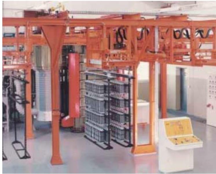
Şekil 4.5 Parçaların vakum sert lehimi için fikstüre yüklenmesi. (Andersson ve dg., 2011)
