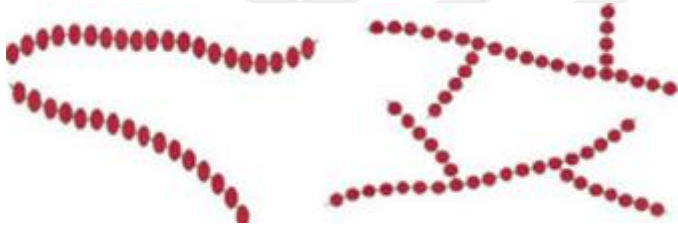
Şekil 2.4. Termoplastik yapıdaki polimerlerin zincir yapıları (Ay, 2008)
