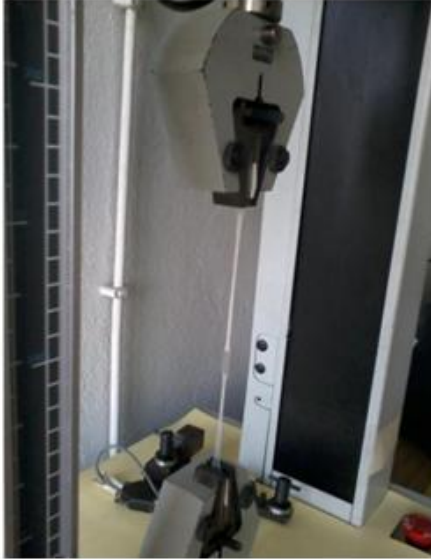
Resim 3.1. Çekme test cihazı (Şişmanoğlu, 2020)
