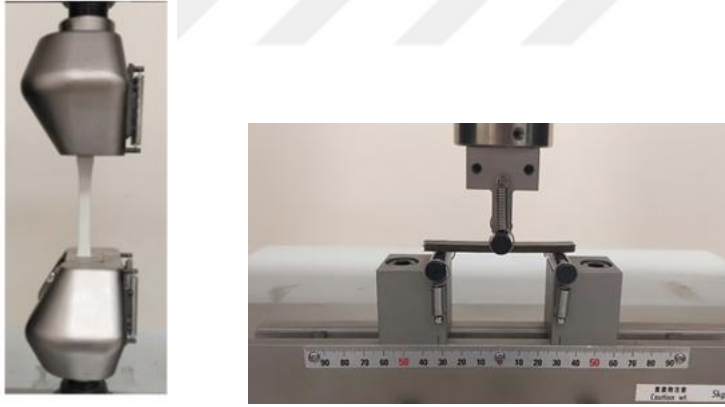
Resim 5.6. Shimadzu ag-x 10” ile gerçekleştirilen çekme ve üç nokta eğilme deneyleri
