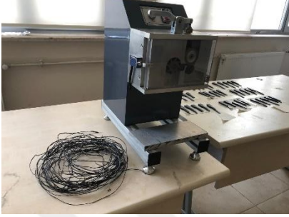
Resim 5.3. Granül eldesi için kullanılan kırıcı
