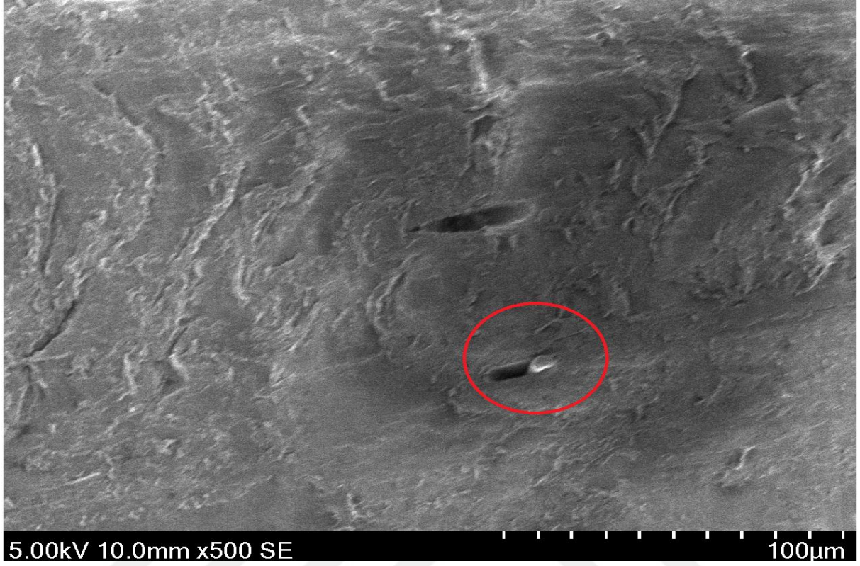
Resim 6.10. Ağırlıkça %30 dolgu Maddesi-1 içeren YYPE numunesine ait kesit görüntüsü
