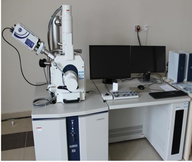
Resim 5.8. HITACHI SU 3500 marka taramalı elektron mikroskobu
