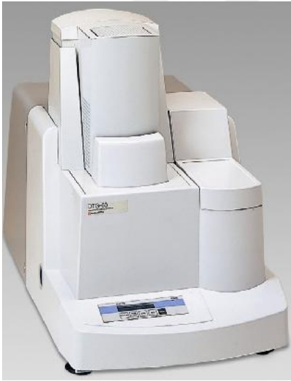
Resim 5.7. DTG 60 TGA/DTA cihazı
