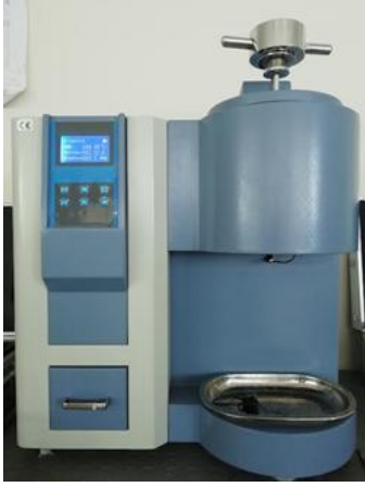
Resim 5.1. JPT EQUIPMANT marka XRL-400A model” Melt Flow Index eriyik akış cihazı.
