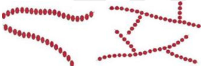
Şekil 2.4. Termoplastik yapıdaki polimerlerin zincir yapıları (Ay, 2008)
