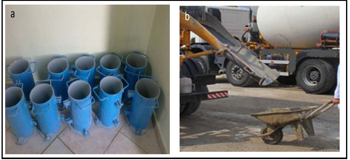
Şekil 3.2: Kalıp ve Numune Temini
