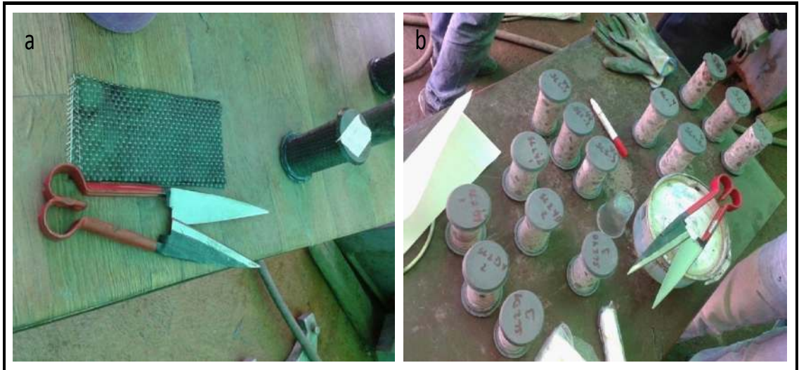
Şekil 3.36. Karbon Elyafın Hazırlanması Ve Numunelere Uygulanması
