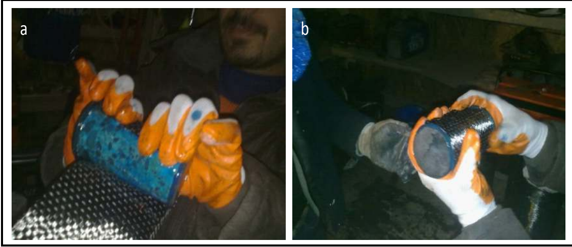
Şekil 3.22. İlk Kat Elyaf Sarılması
