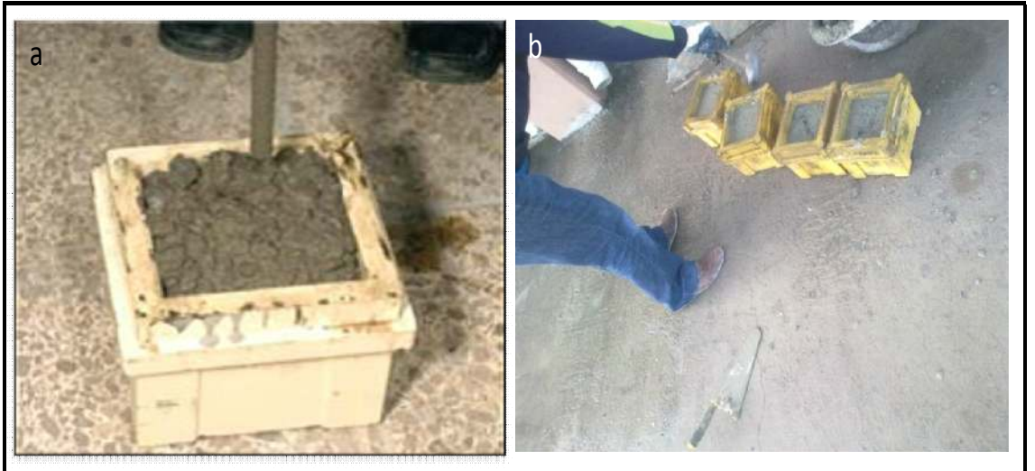
Şekil 3.28. Harcın Küp Kalıplara Koyulması
