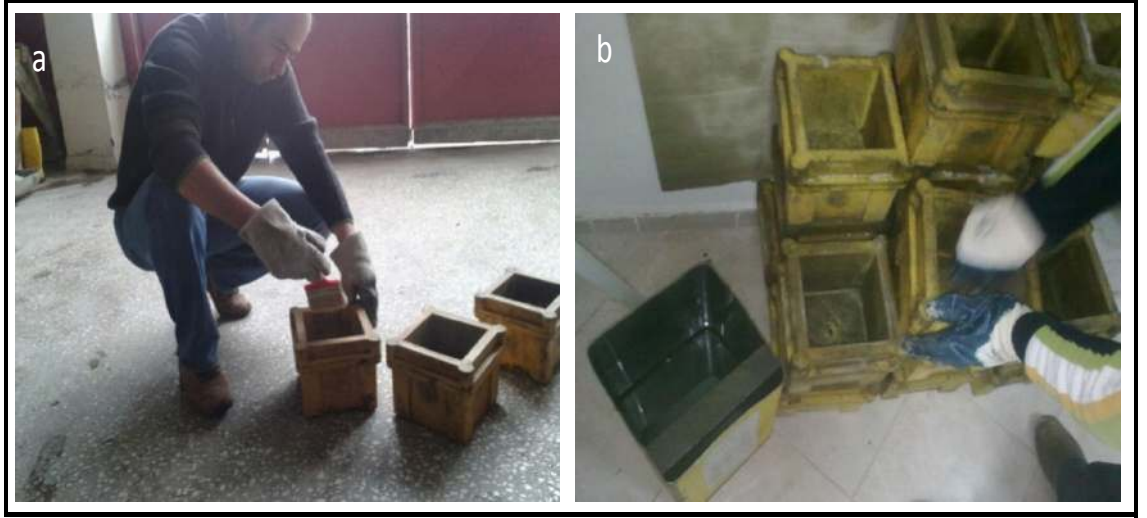
Şekil 3.27. Küp Kalıpların Temizlenmesi ve Yağlanması
