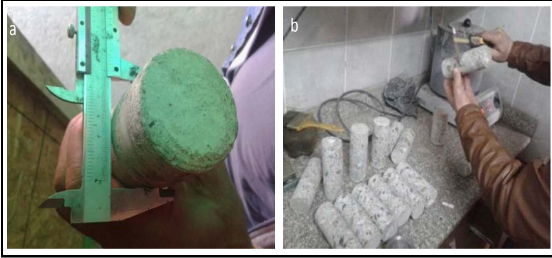
Şekil 3.33. Karot Numunelerin Ölçülendirilmesi
