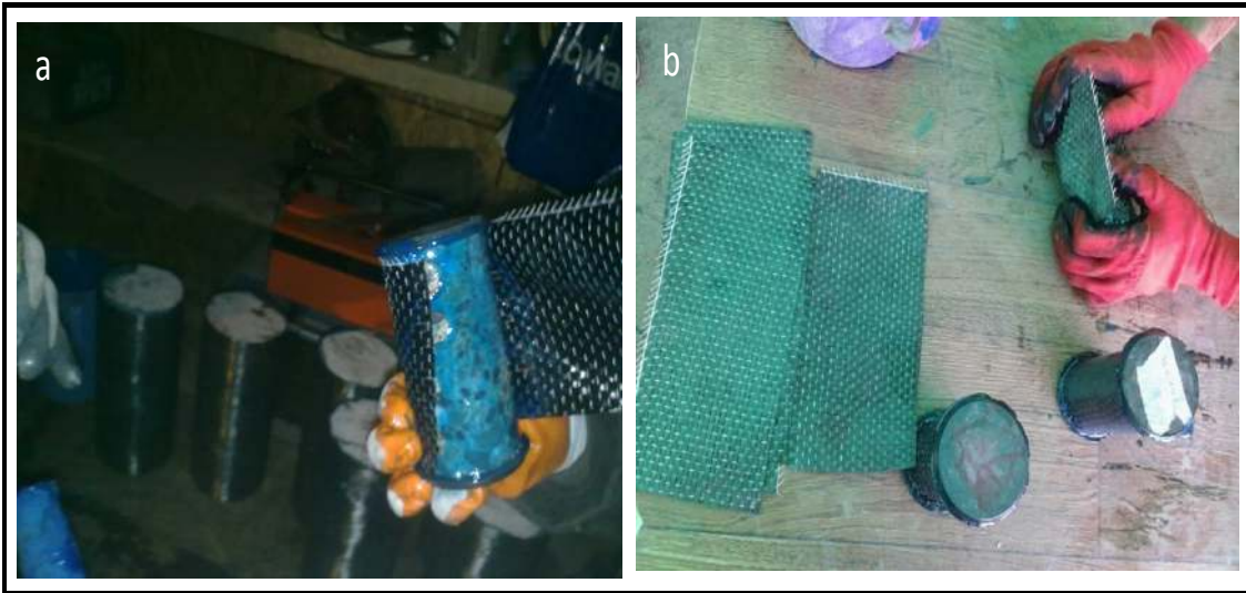
Şekil 3.37. Numunelere İkinci Kat Karbon Elyaf Sarılması
