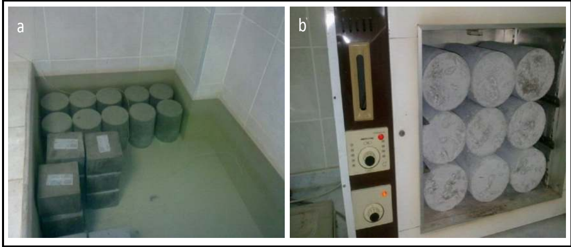
Şekil 3.5: Numunelerin Kürlenmesi ve Kurutulması
