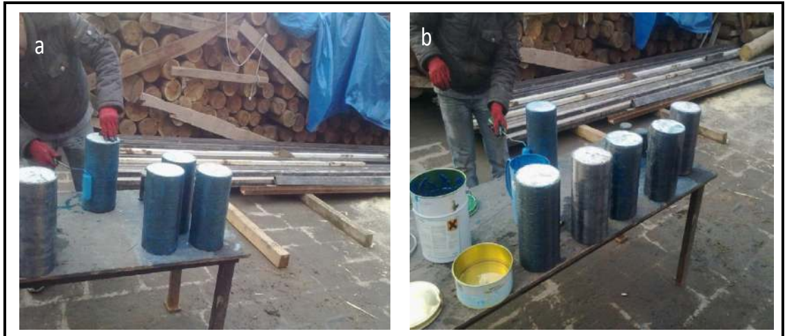
Şekil 3.10: Son Kat Epoksinin Sürülmesi
