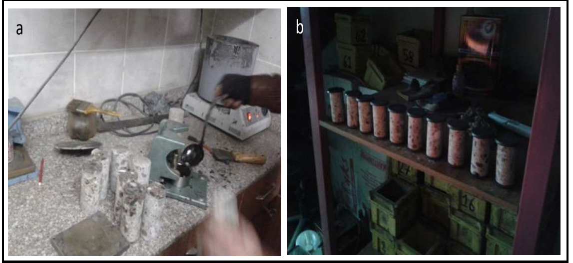
Şekil 3.35. Karot Numunelerin Başlıklandırılması
