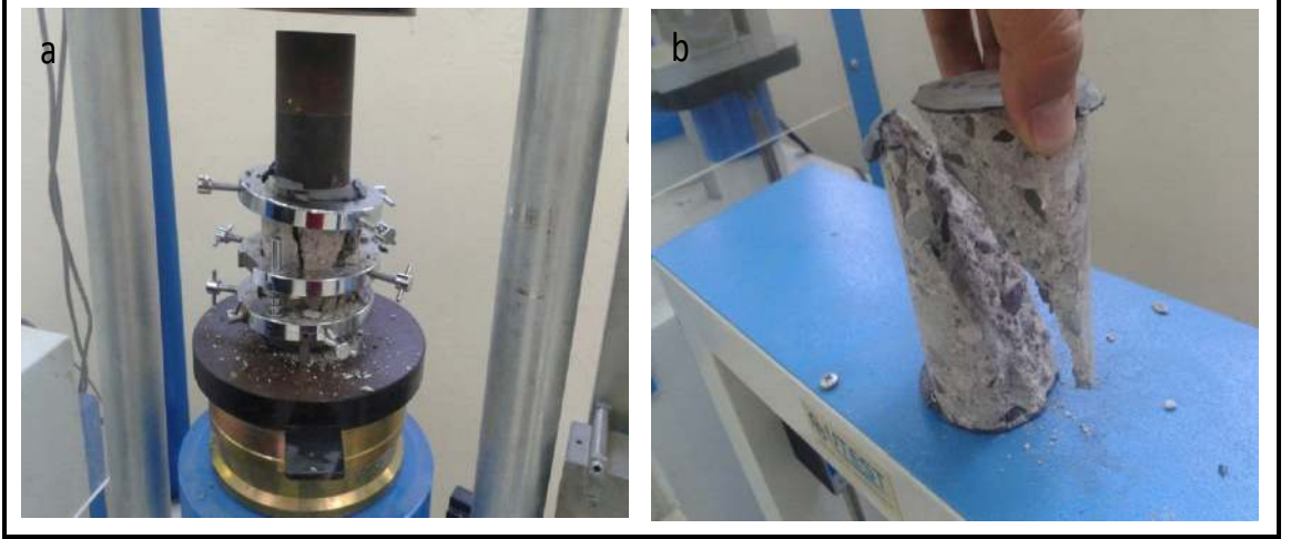
Şekil 3.24. Karot Numunelerin Deneye Alınması
