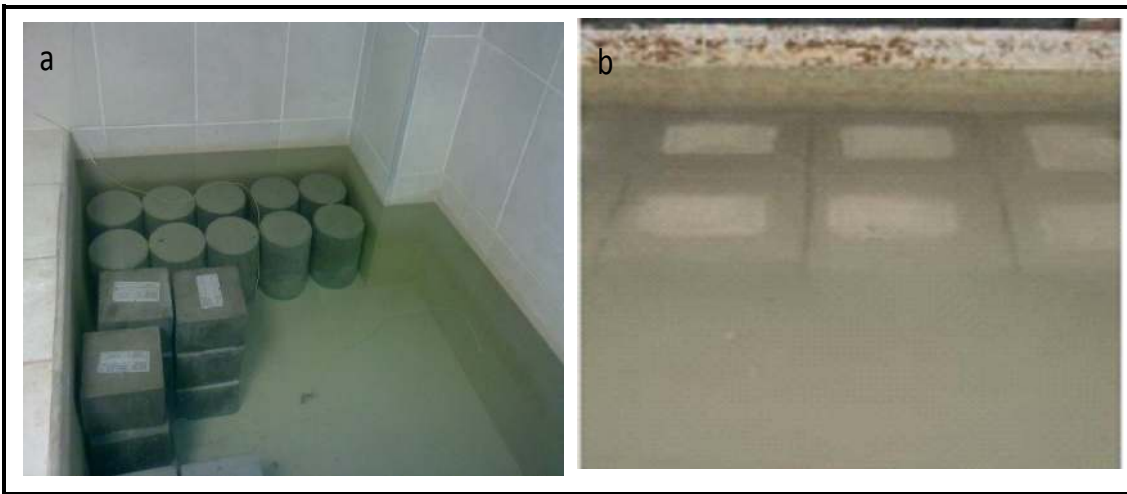
Şekil 3.30. Küp Numunelerin Kürlenmesi
