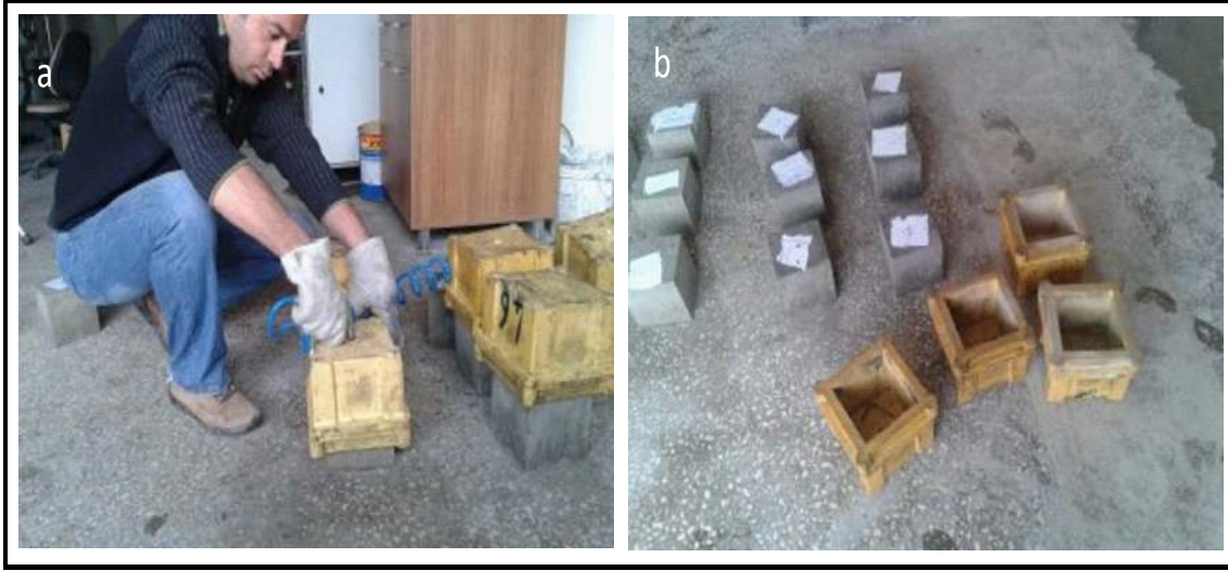
Şekil 3.29. Numunelerin Kalıptan Çıkarılması
