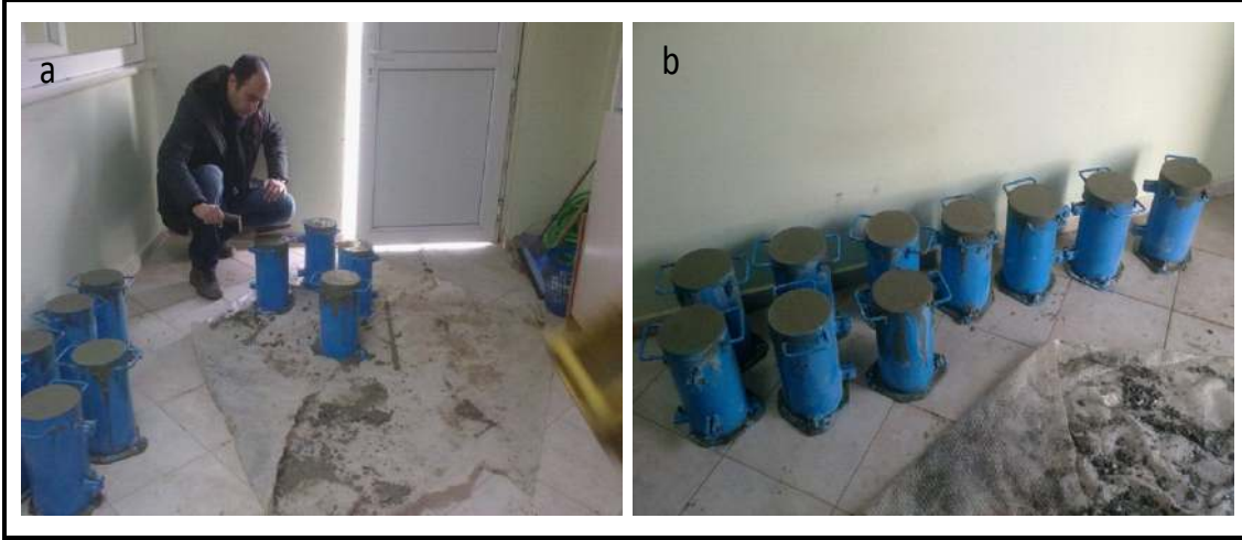
Şekil 3.4: Taze Beton Numunelerinin Bekletilmesi
