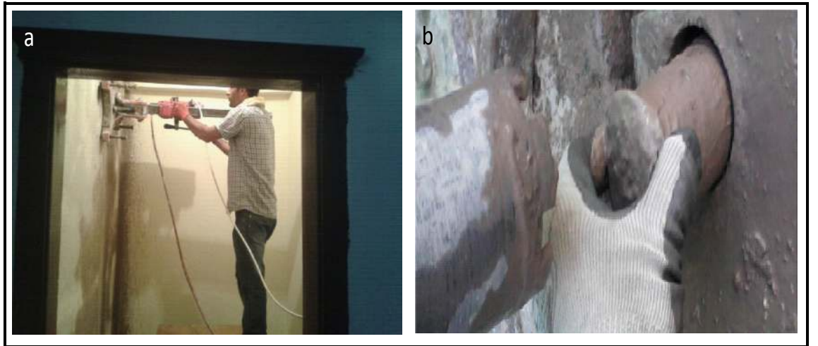
Şekil 3.17: Yapıdan Karotların Alınması
