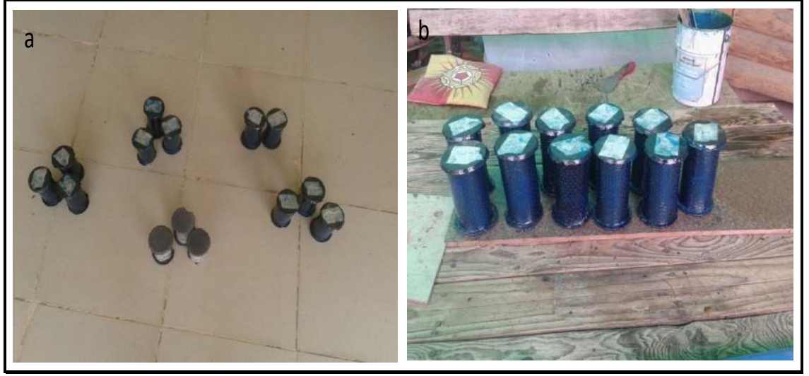
Şekil 3.38. Karot Numunelerin Deney İçin Hazırlanması
