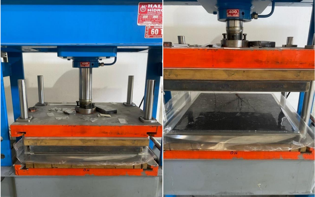
Şekil 3.7. Hot press işlemi
