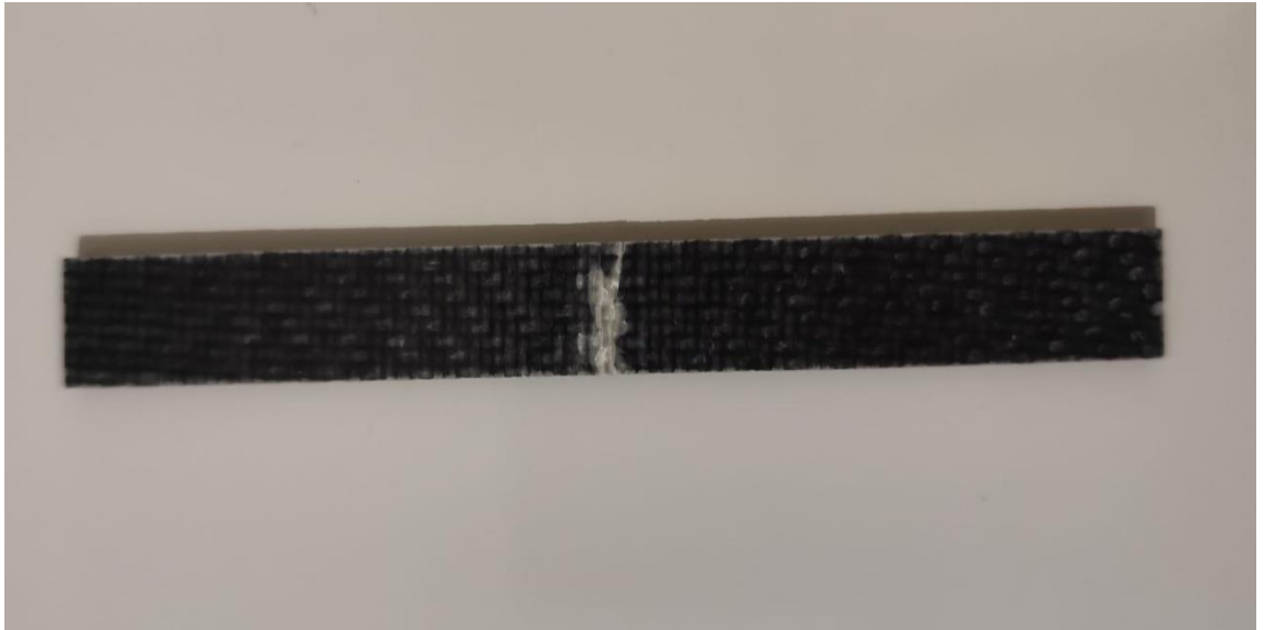
Şekil 3.17. Üç noktadan eğme testine tabi tutulan numunenin son hali
