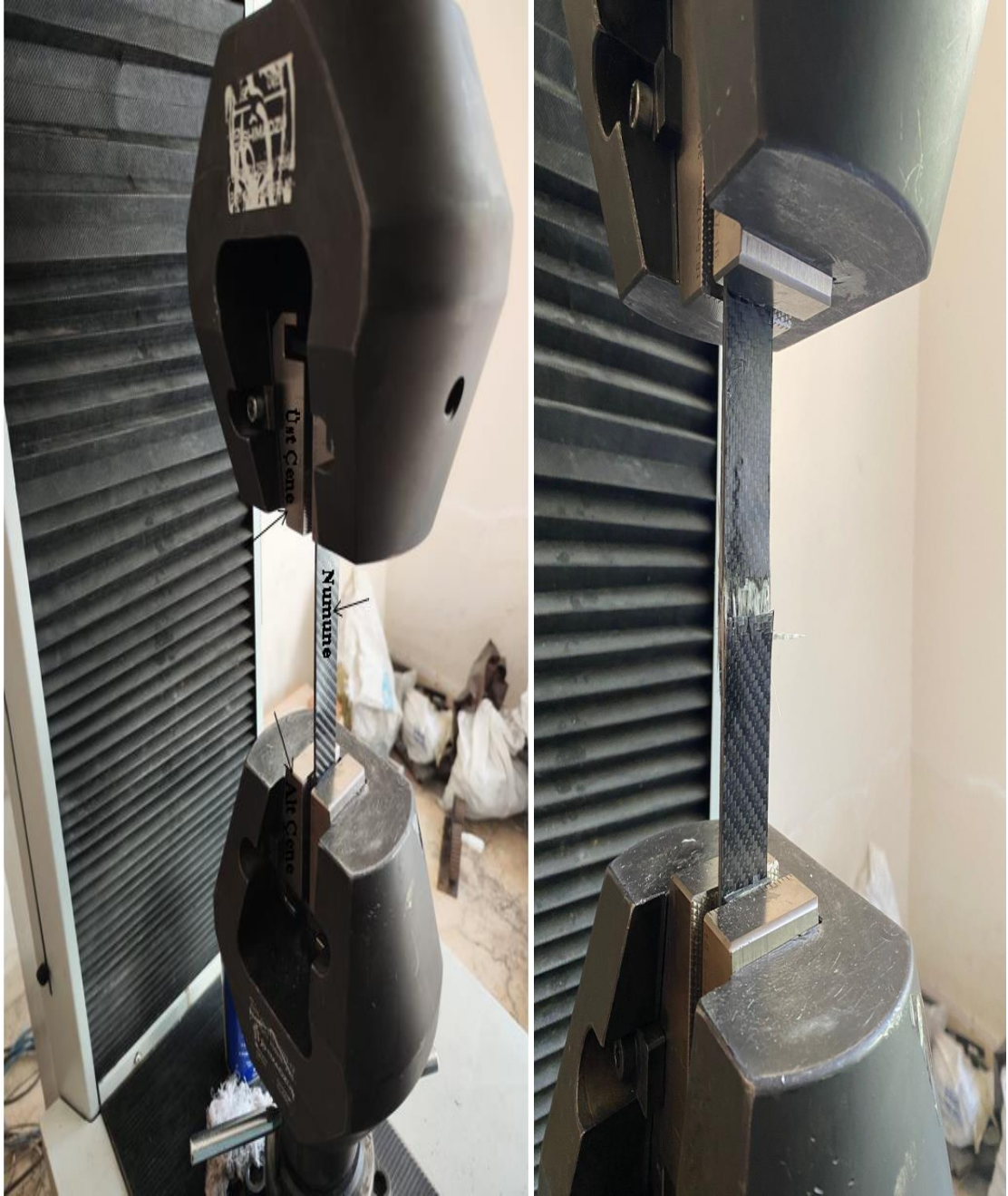
Şekil 3.12.Çekme test cihazı ve deneyin yapılışı
