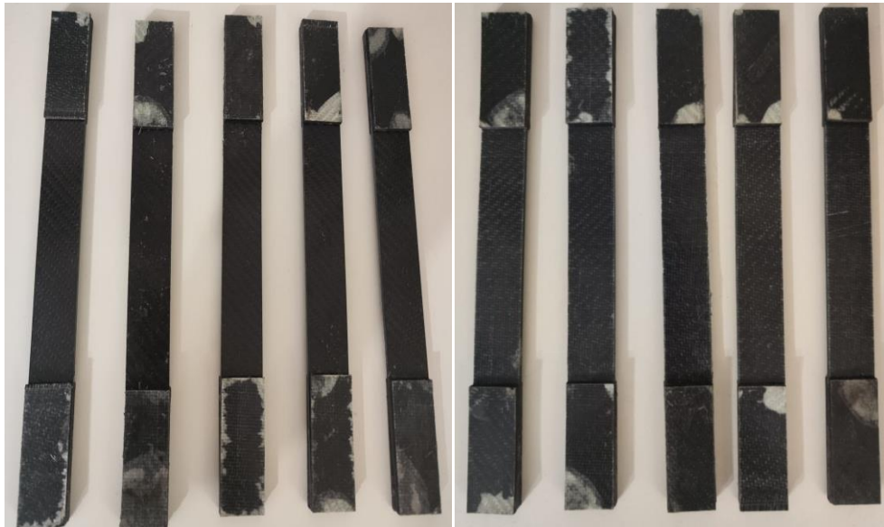
Şekil 3.11. Çekme testi öncesi pabuç takılmış kompozit numunelerin görüntüsü
