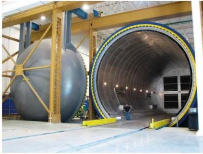
Şekil 2.13. Otoklav metodu (Kahraman, 2017)
