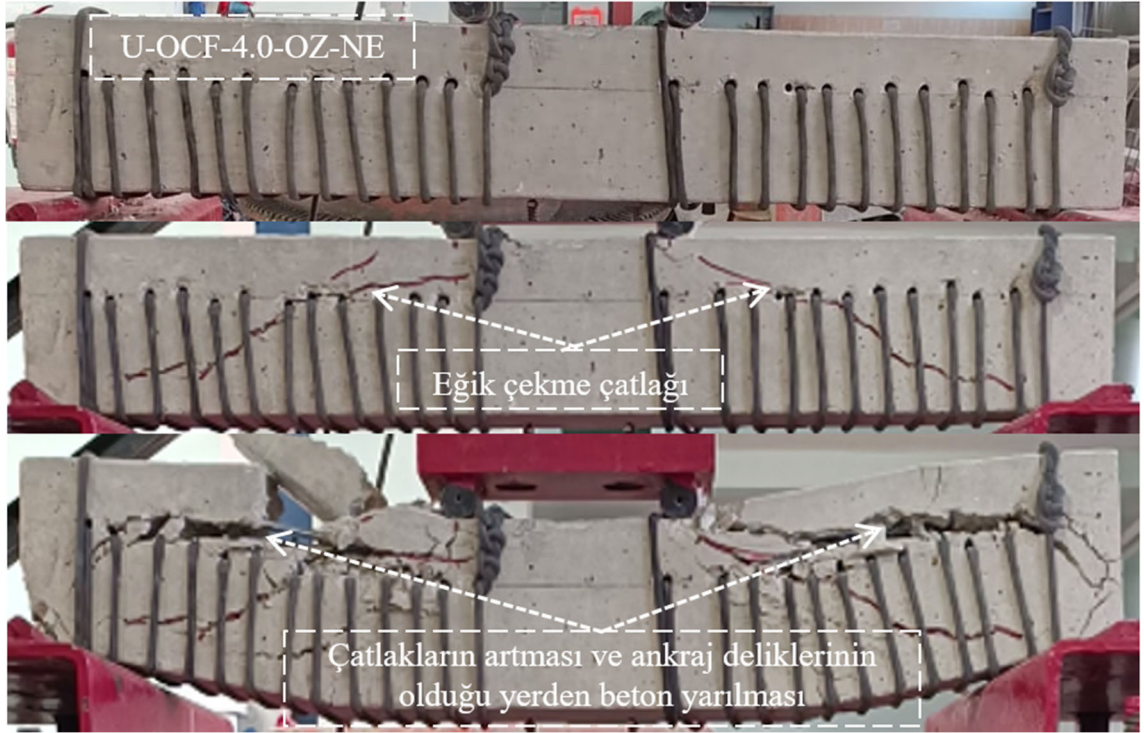
Şekil 4.24. U-OCF-4.0-OZ-NE kiriş numunesine ait göçme sonrası hasar detayları
