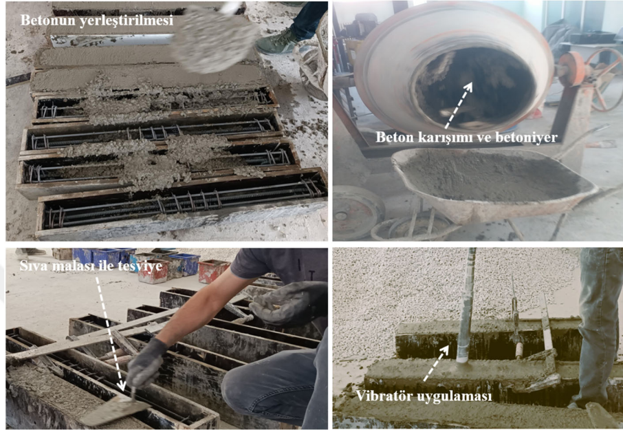
Şekil 3.4. Deney numuneleri için betonun karıştırılması ve kalıplara yerleştirilme aşamaları
