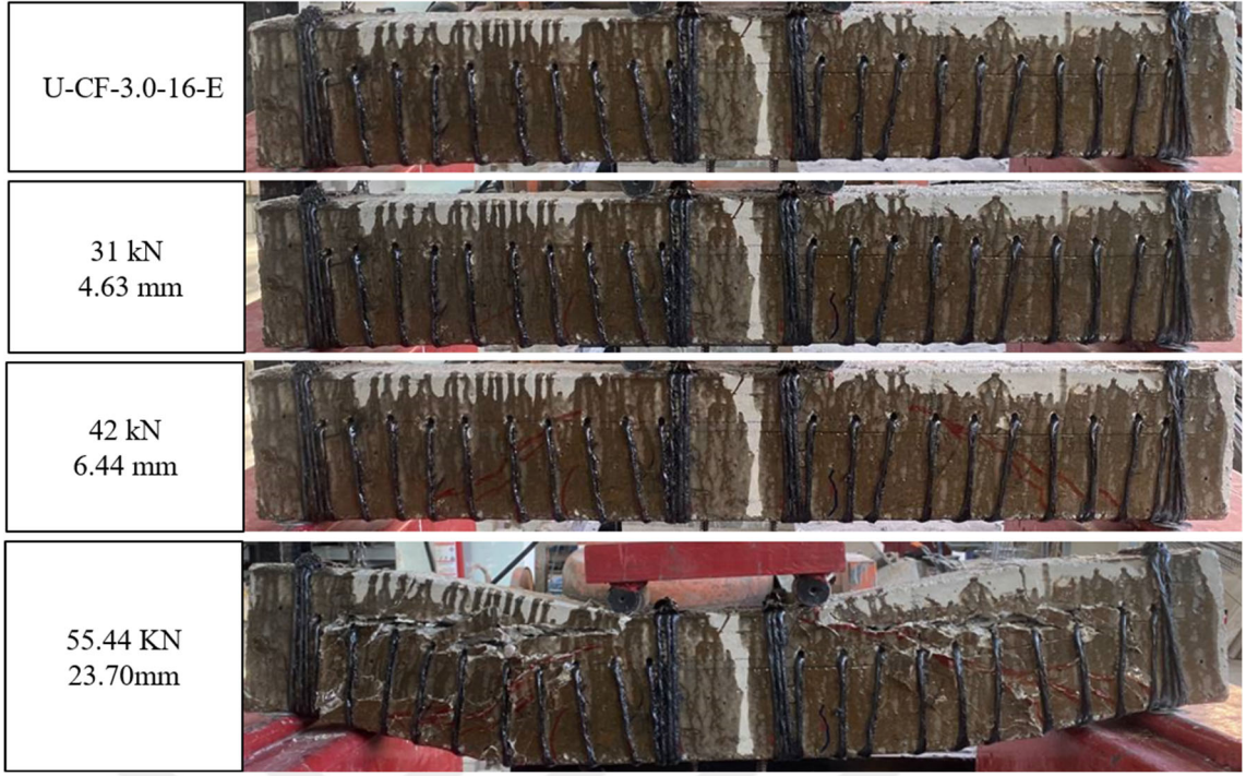
Şekil 4.25 U-CF-3.0-16-E kiriş numunesine ait çatlak oluşum aşamaları
