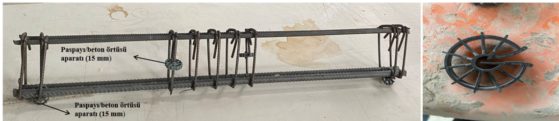
Şekil 3.8. Deney kirişlerinde kullanılan paspayı/beton örtüsü aparatları
