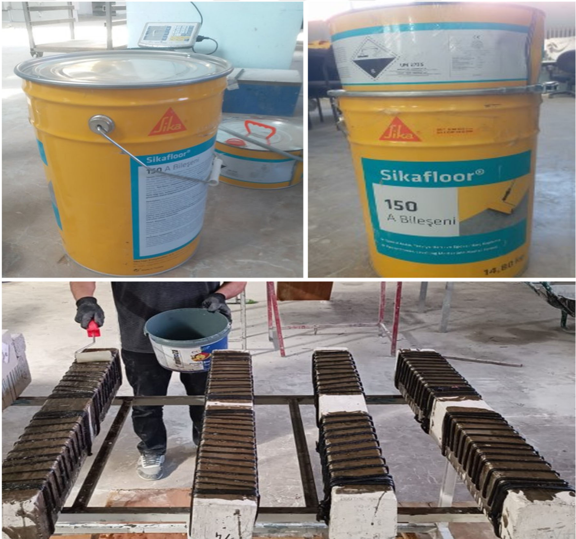
Şekil 3.9. Güçlendirme uygulamasında kullanılan epoksi malzemesi
