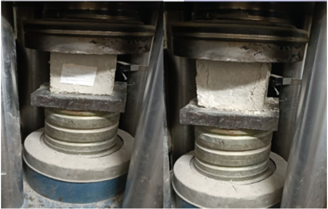
Şekil 3.6. Beton basınç dayanımının belirlenmesi
