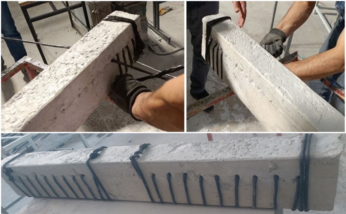
Şekil 3.11. FRP demeti/ipi ve özel üretim FRP ipin deliklerden geçirilmesi
