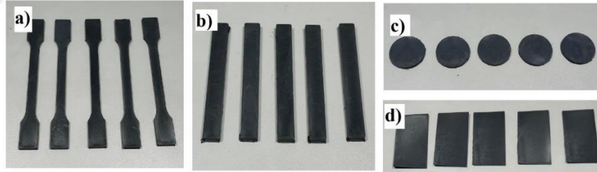
Şekil 4.8: PBT/CF10/SiC30/MPP a) Çekme, b) Darbe, c) İletkenlik, d) UL94.
