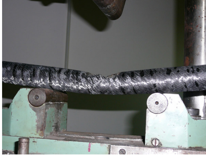
Şekil 4.61 Yük kaldırıldıktan sonra borunun görünümü
