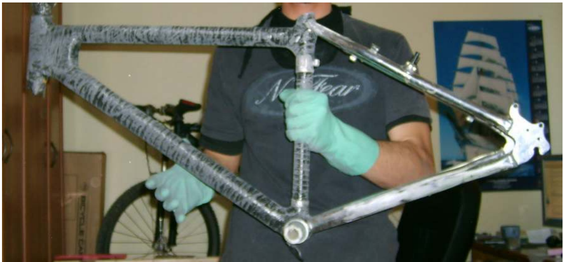
Şekil 4.23 Üst ve Alt boruların ilk katman sarımları tamamlanmış ve zımparalanmış
