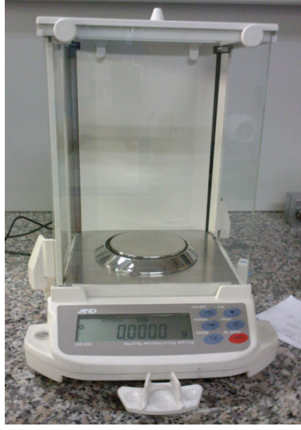
Şekil 4.38 Hacim oranı tayini sırasında kullanılan hassas terazi
