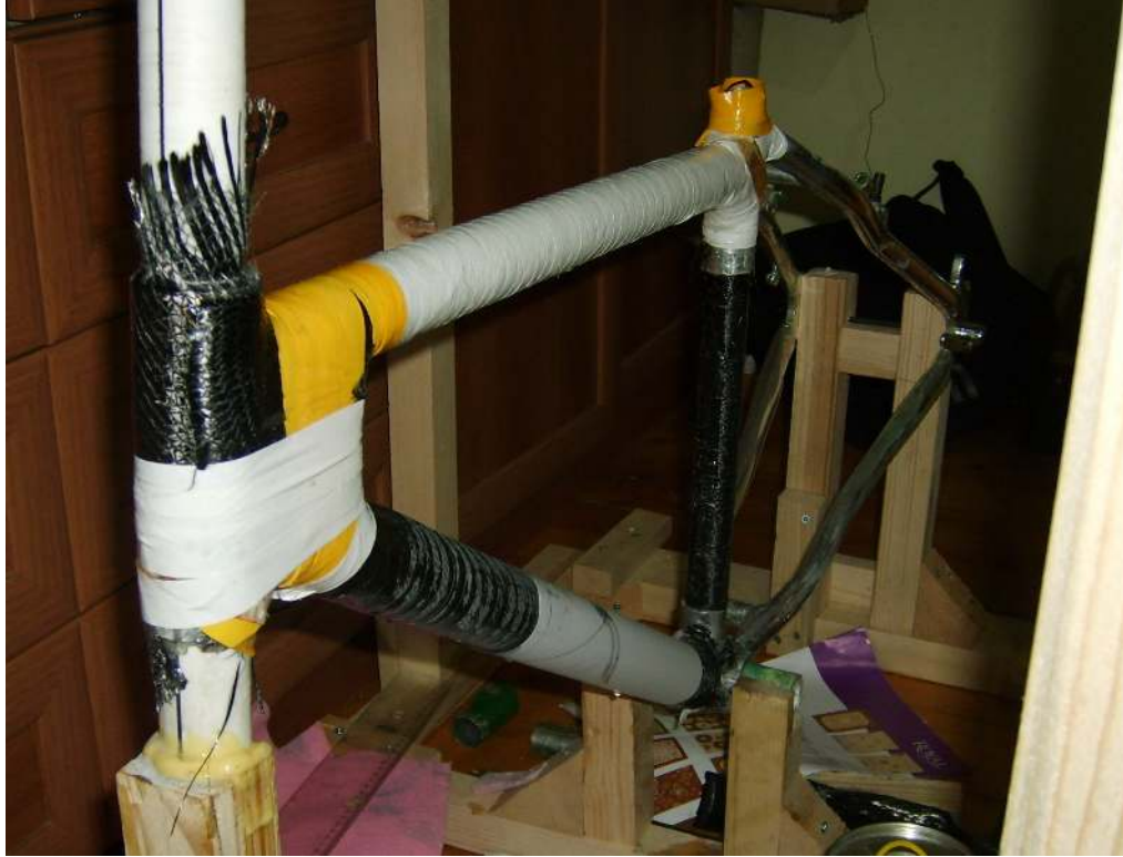
Şekil 4.22 İlk karbon fiber katmanı sarım işlemi tamamlanmış ve üzeri PVC bant ile sarılmış durumda
