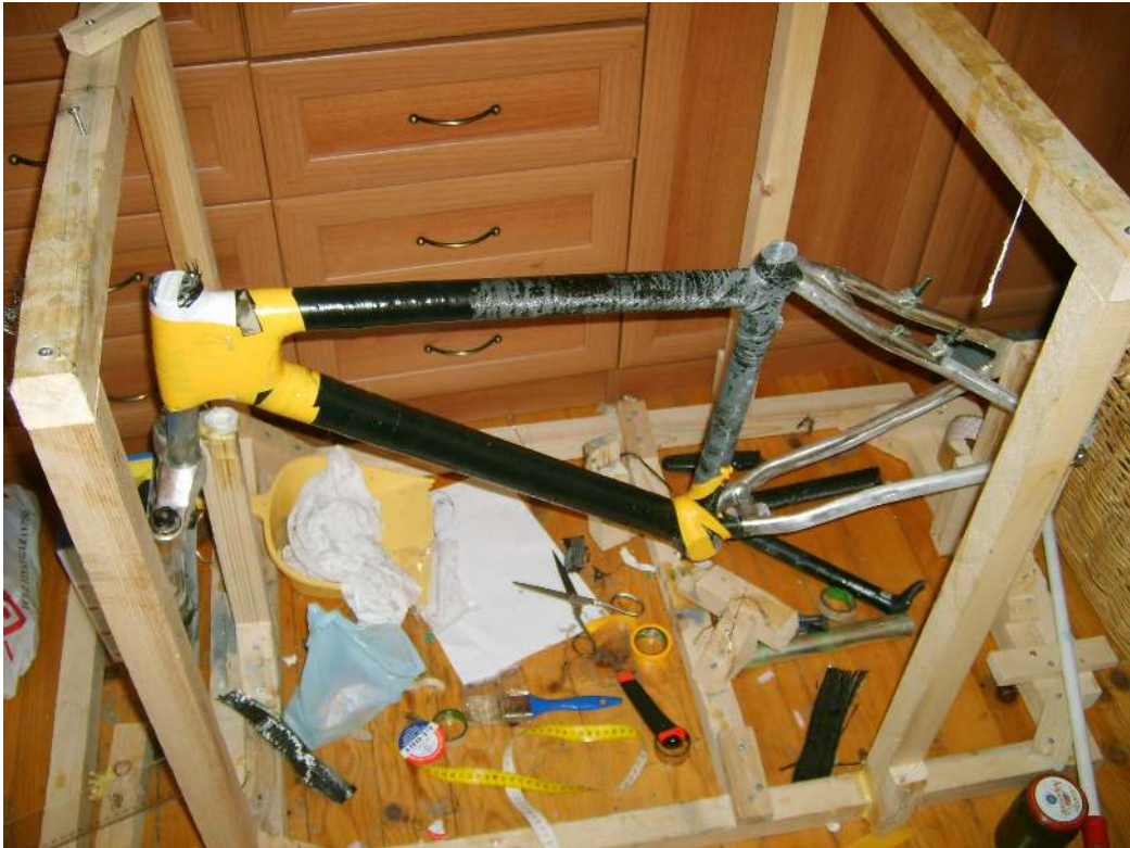
Şekil 4.29 Son katmanlar sarılırken kadronun ve tezgahın görünümü
