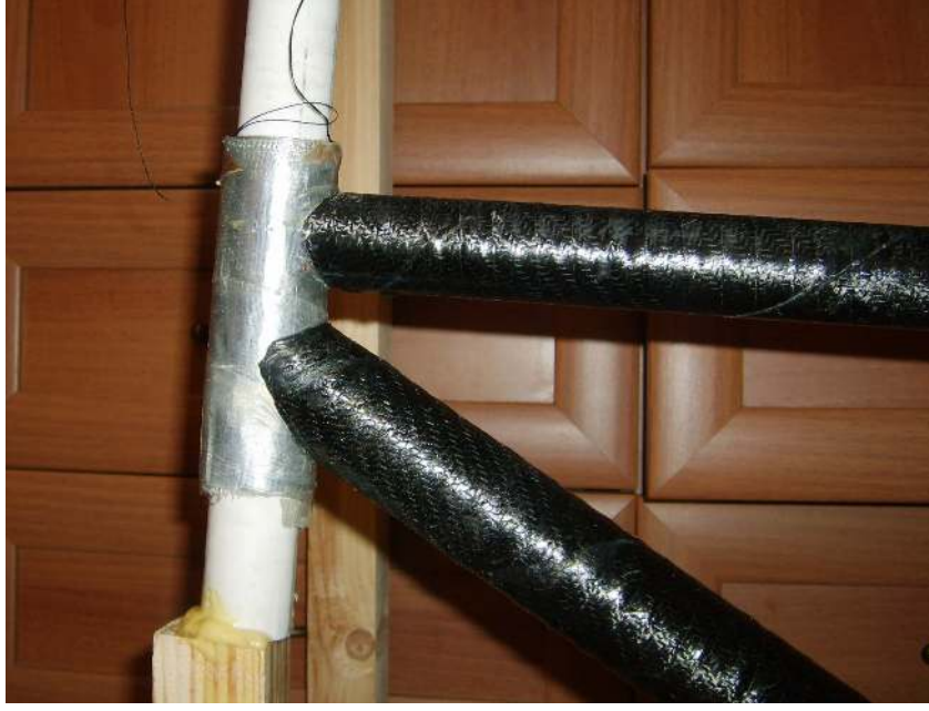
Şekil 4.16 Üst ve alt borular aln borusu üzerinde kurt ağı birleşimi ile birbirlerine eklenmiş durumda.
