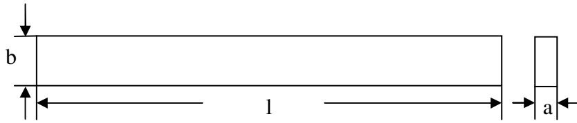
Şekil 4.65 Çekme deneyi numunelerinin boyutları
