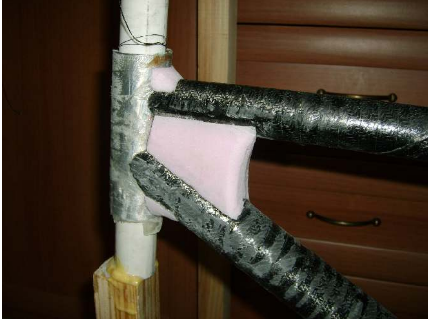
Şekil 4.19 Üst ve alt iç boruların kesişme noktalarında dolgu malzemesi köpük görülmekte.
