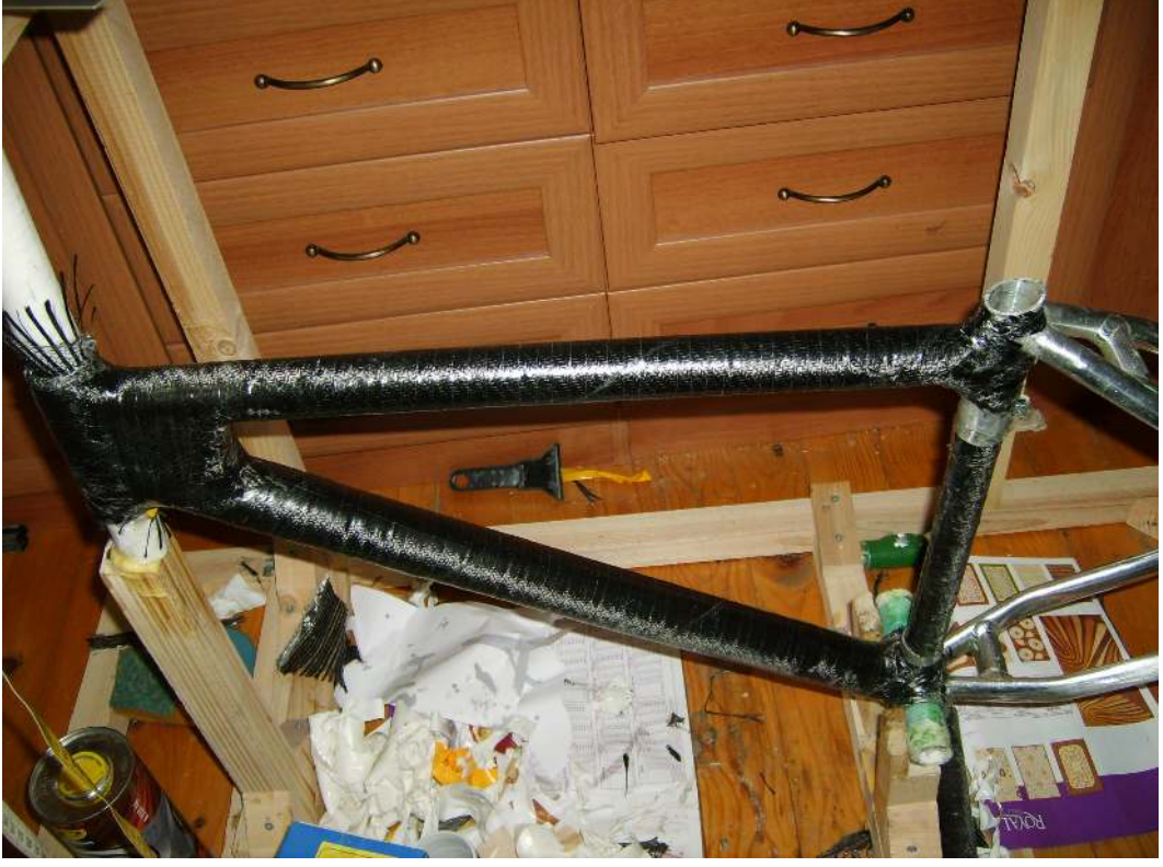
Şekil 4.26 İkinci katmanlar sonrası kadronun görünümü
