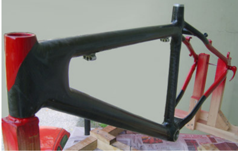
Şekil 4.32 Kadro boyanmış ve verniklenmiş durumda
