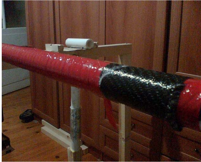
Şekil 4.14 İç katman borularının sarılması
