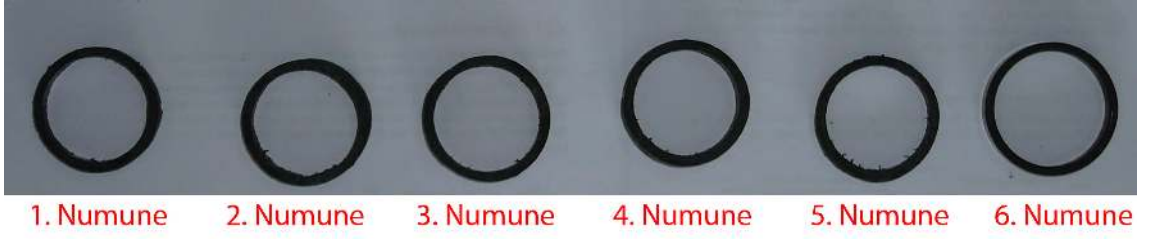
Şekil 4.52 Halka eğme deney numuneleri
