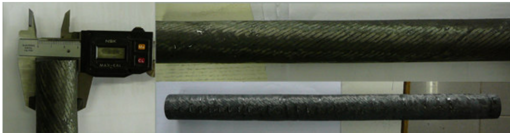
Şekil 4.57 Boru deney numuneleri ve dış çap ölçümü
