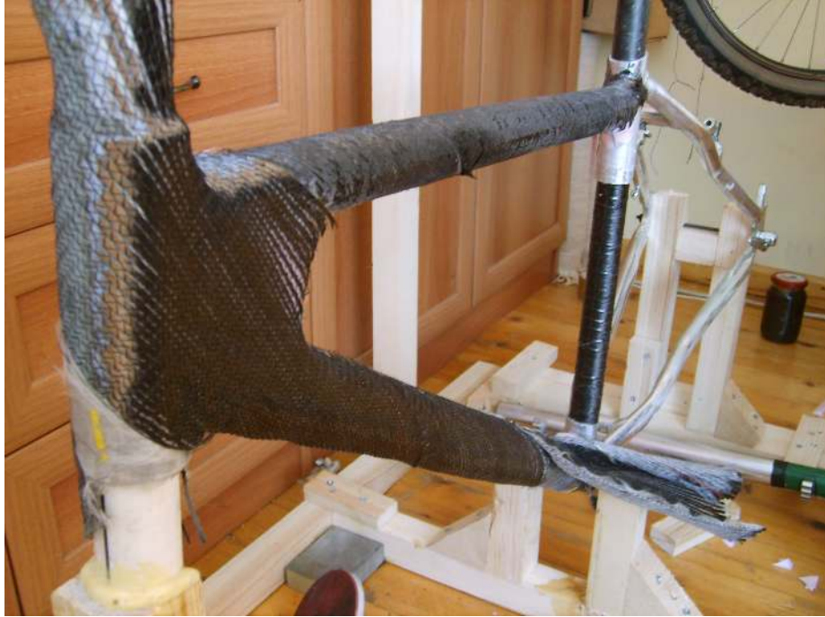
Şekil 4.21 İlk karbon fiber katmanı sarım öncesi alıştırılıyor.
