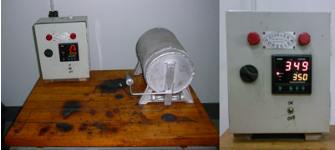
Şekil 4.39 Hacim oranı tayini sırasında kullanılan fırın
