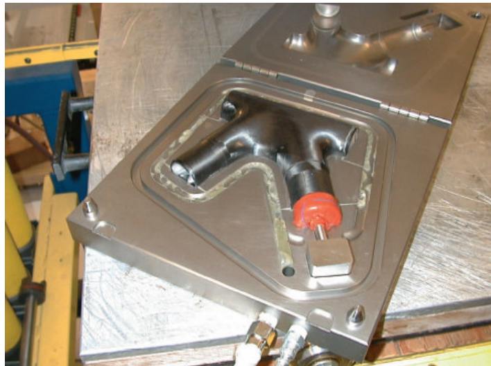
Şekil 3.6 Keseli kalıplama (Bladder Molding) yöntemi ile üretilen Trek alın rekoru (Lizotte, 1996)
