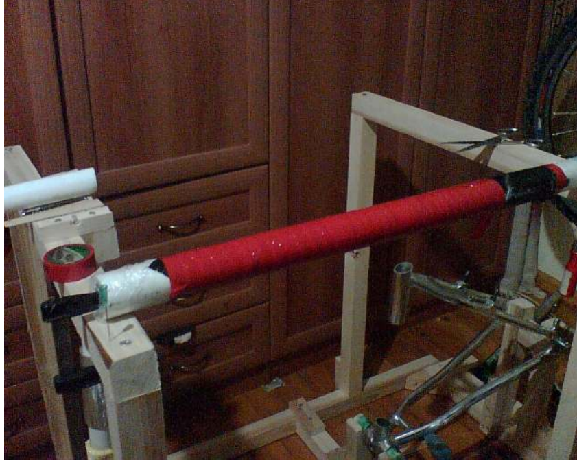
Şekil 4.13 İç katman borularının hazırlanması. Fiberler sarılmış ve üzerleri pvc bant ile kaplanmış durumda
