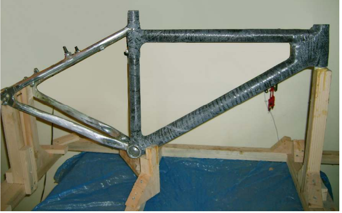
Şekil 4.30 Kadronun sarım işlemleri tamamlanmış ve zımparalanmış
