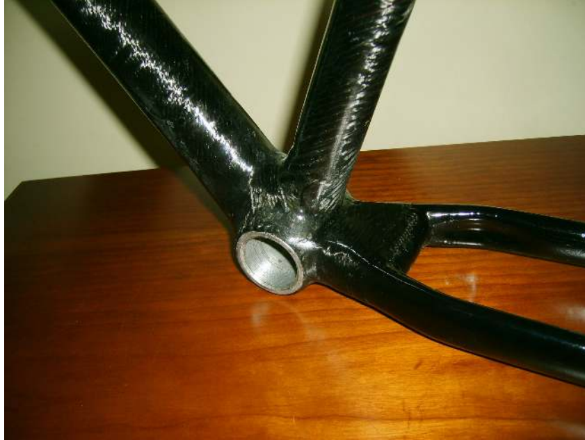
Şekil 4.33 Kadronun tamamlanmış hali, orta göbek ve çeki borusu köprüsü
