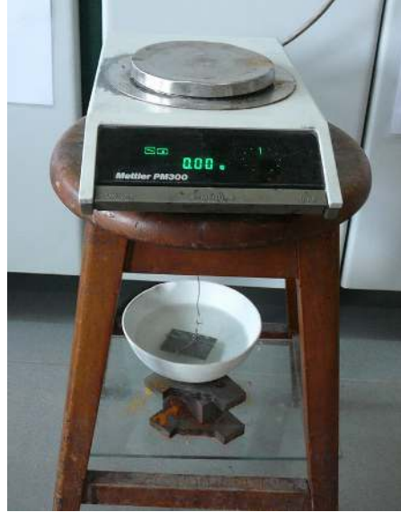
Şekil 4.36 Ağırlık ve hacim ölçümü yapılacak olan hassas tartı
