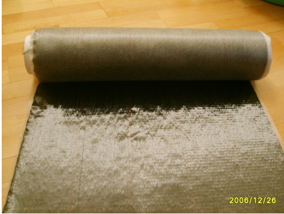
Şekil 4.10 12K Tek eksenli karbon fiber.
