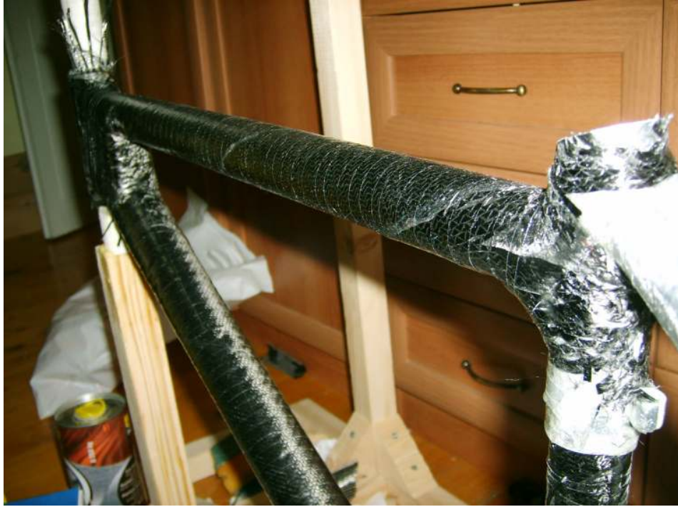
Şekil 4.24 Katılaşması tamamlanmış ilk katman. Sökülen PVC bantların izleri görülmekte.
