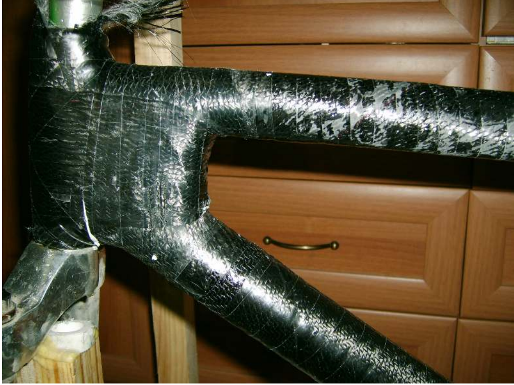
Şekil 4.28 Beşinci katmanlar sonrası ön tarafın görünümü
