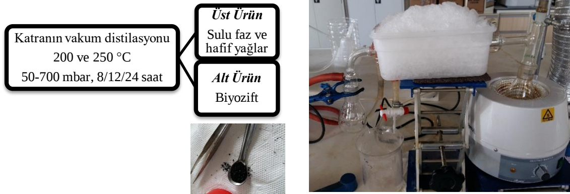
Şekil 7.5. Katrandan biyozift üretim akış diyagramı ve deney düzeneği.
