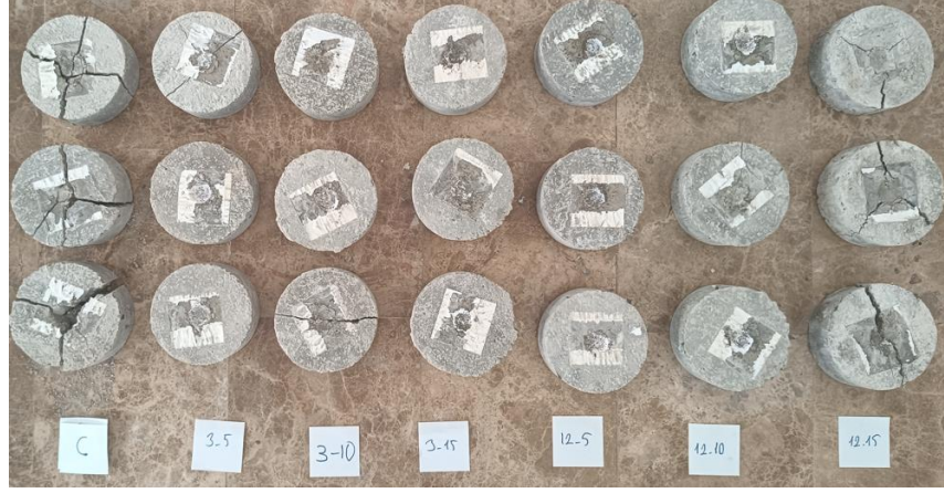
Şekil 6.25. Darbe testlerinden sonra numuneler
