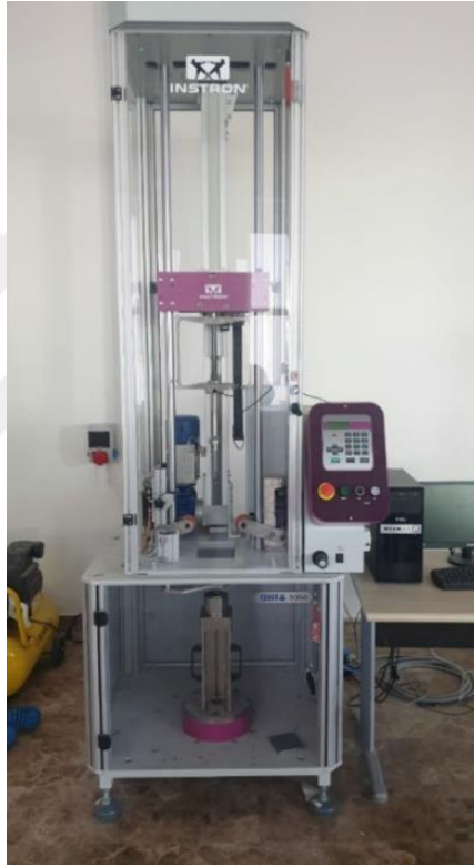
Şekil 4.4. Aletli ağırlık düşürme test sistemi [27]
