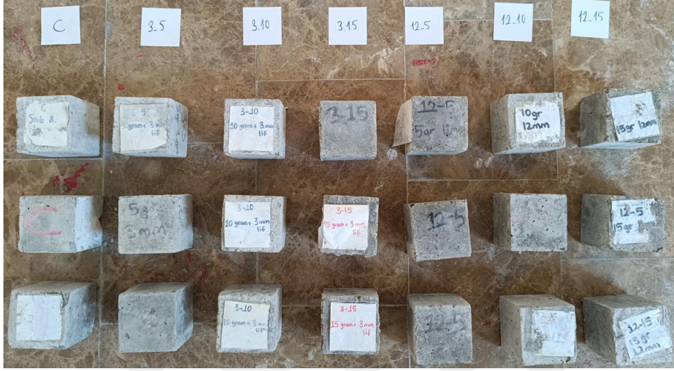
Şekil 6.2. Basınç deneylerinden sonra küp numuneler
