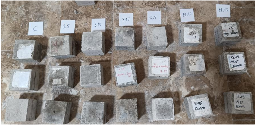
Şekil 6.3. Yarma deneylerinden sonra küp numuneler
