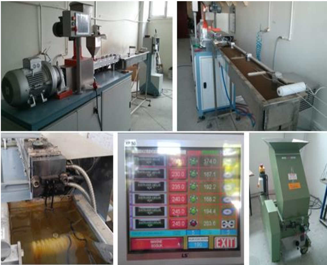
Şekil 4.2. ÇDKNT katkılı PA6 nanokompozitlerin ekstruder üretim süreci.
