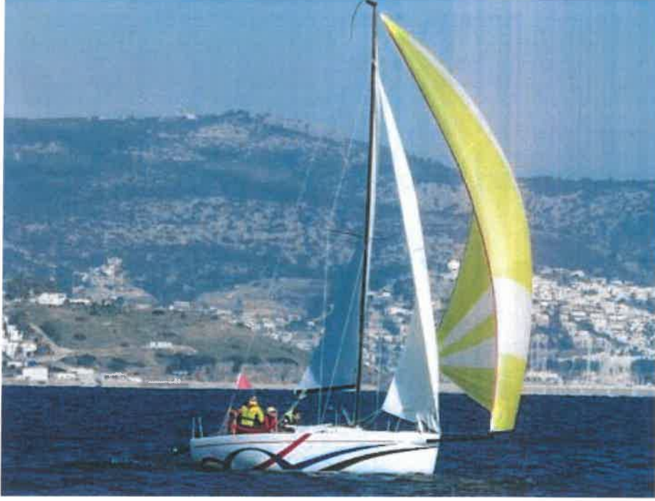
Şekil 1.12. Direği güçlendirmek için karbon fiberler ve nanotüplerle yapılmış yelkenli tekne
