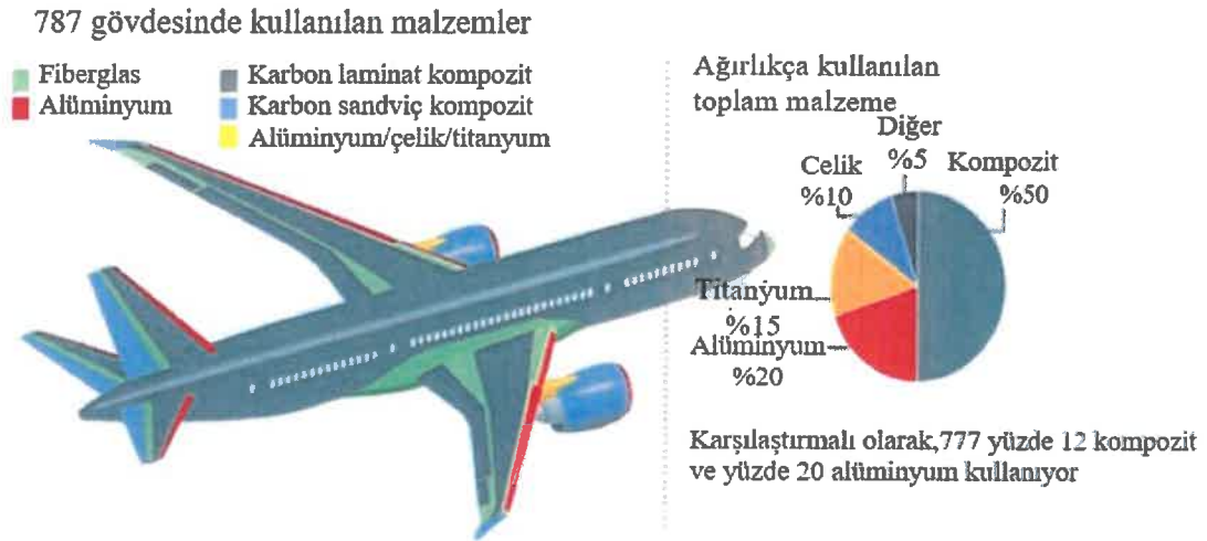
Şekil 1.1. Boeing 787 Dreamliner'da çeşitli malzemelerin kullanımı (Katunin vd. 2017; Rosato 2013)
