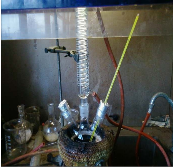
Resim 7.1. ÇDKNT yüzeyinin maleik anhidrit (MA) ile fonksiyonlaştırılmasına ait deney düzeneği
