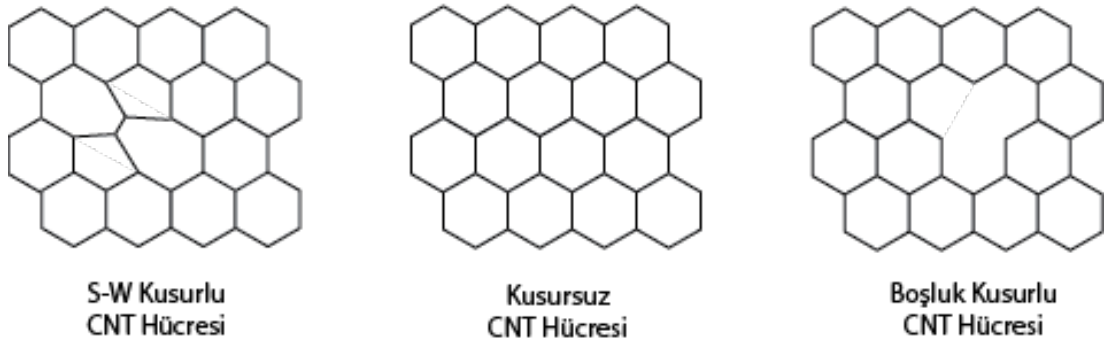
Şekil 1.5 Yaygın görülen kusurların şematik gösterimi
