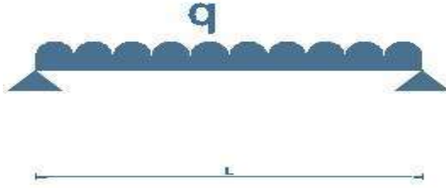
Şekil 3.8. Basit mesnet ve uygulanan yayılı yük
