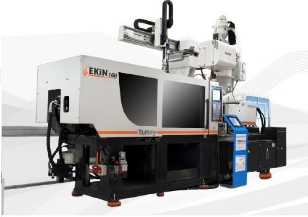
Fotoğraf 2.4. Kullanılan Ekin 160 Orion enjeksiyon makinesi
