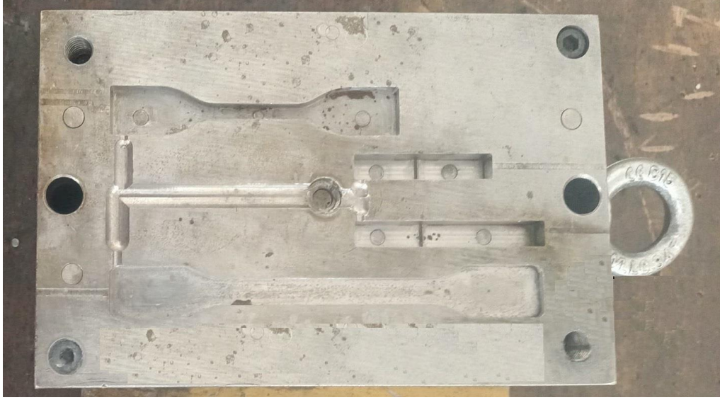
Fotoğraf 2.6. ISO 527-4'e uygun olarak üretilmiş enjeksiyon kalıbı
