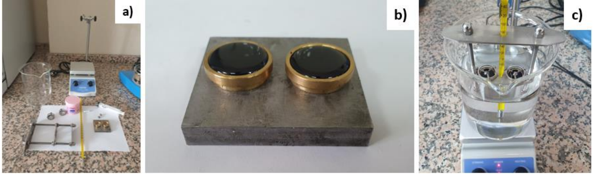
Resim 3.7 Bitüm yumuşama noktası deneyi aşamaları, a) Deneyde kullanılacak alet ve aparatlar, b) Bitümün yüzüklere yerleştirilmesi, c) Yüzüklerin cihaza yerleştirilip deneyin başlatılması.
