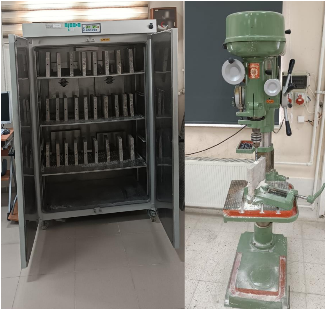
Resim 3.2 Doęal tař numune hazırlama sreci
