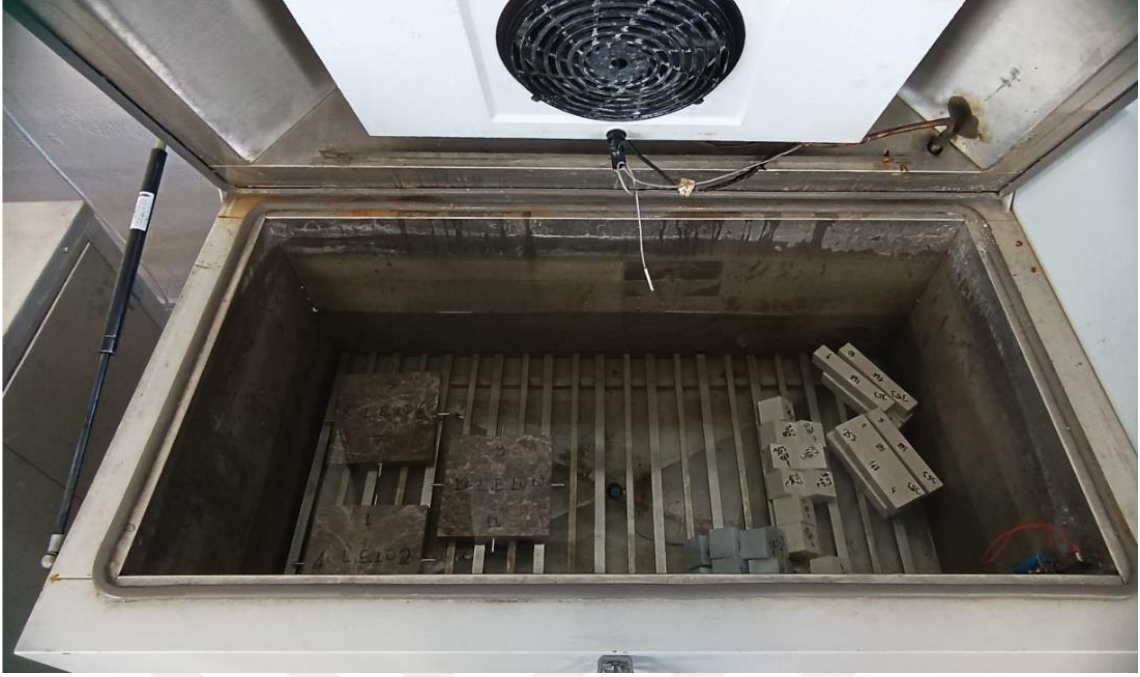
Resim 3.6 Donma-çözülme ekipmanına yerleştirilmiş numuneler
