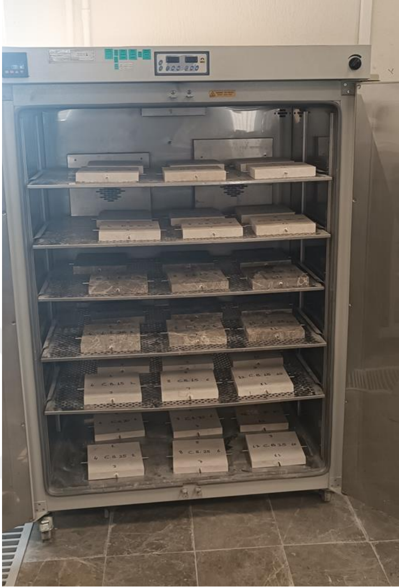
Resim 3.4 Saplama yerleştirilen doğal taş numunelerinin etüv işlem süreci
