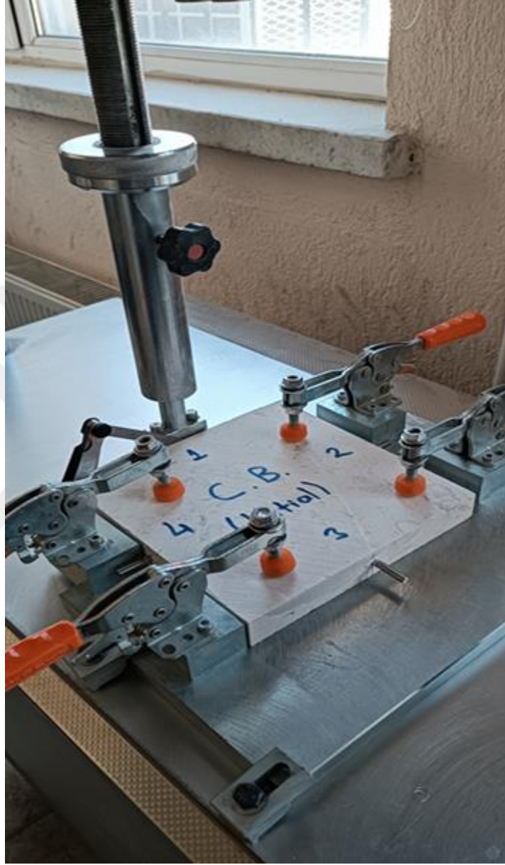
Resim 3.7 Saplama deliğinde kırılma yükü tayini cihazında sabitlenen numune görünümü
