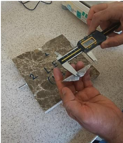
Resim 3.8 Numunelerin kırılma şekillerinin belirlenmesi
