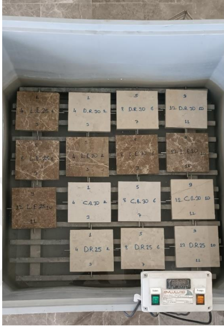
Resim 3.5 Su doldurulacak kaba yerleştirilmiş numuneler
