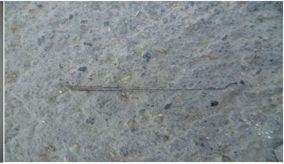
Resim 2.2. Kancalı lifin beton içinde görüntüsü
