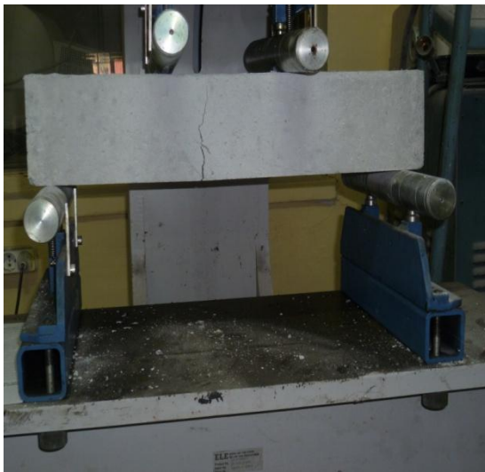
Resim 4.1. Çelik lifli betonun kırılması
