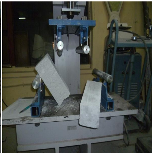
Resim 4.2. Çelik lifsiz betonun kırılması
