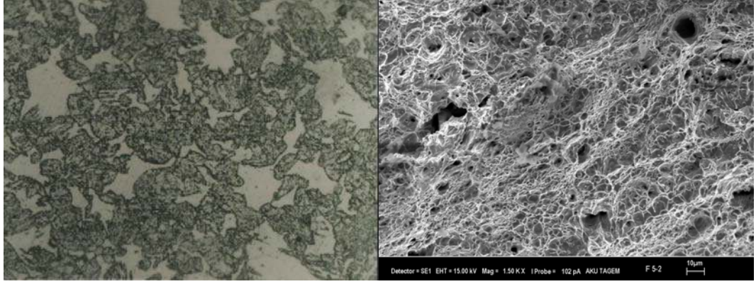
(a) (b) Şekil 7.28 AISI 8620 Çeliği İçin 800 °C Su Verme 500 °C Temperleme Isıl İşleminden Sonraki Durumda a) x500 İç Yapı b) Kırılma Yüzeyi (SEM) x1500.
