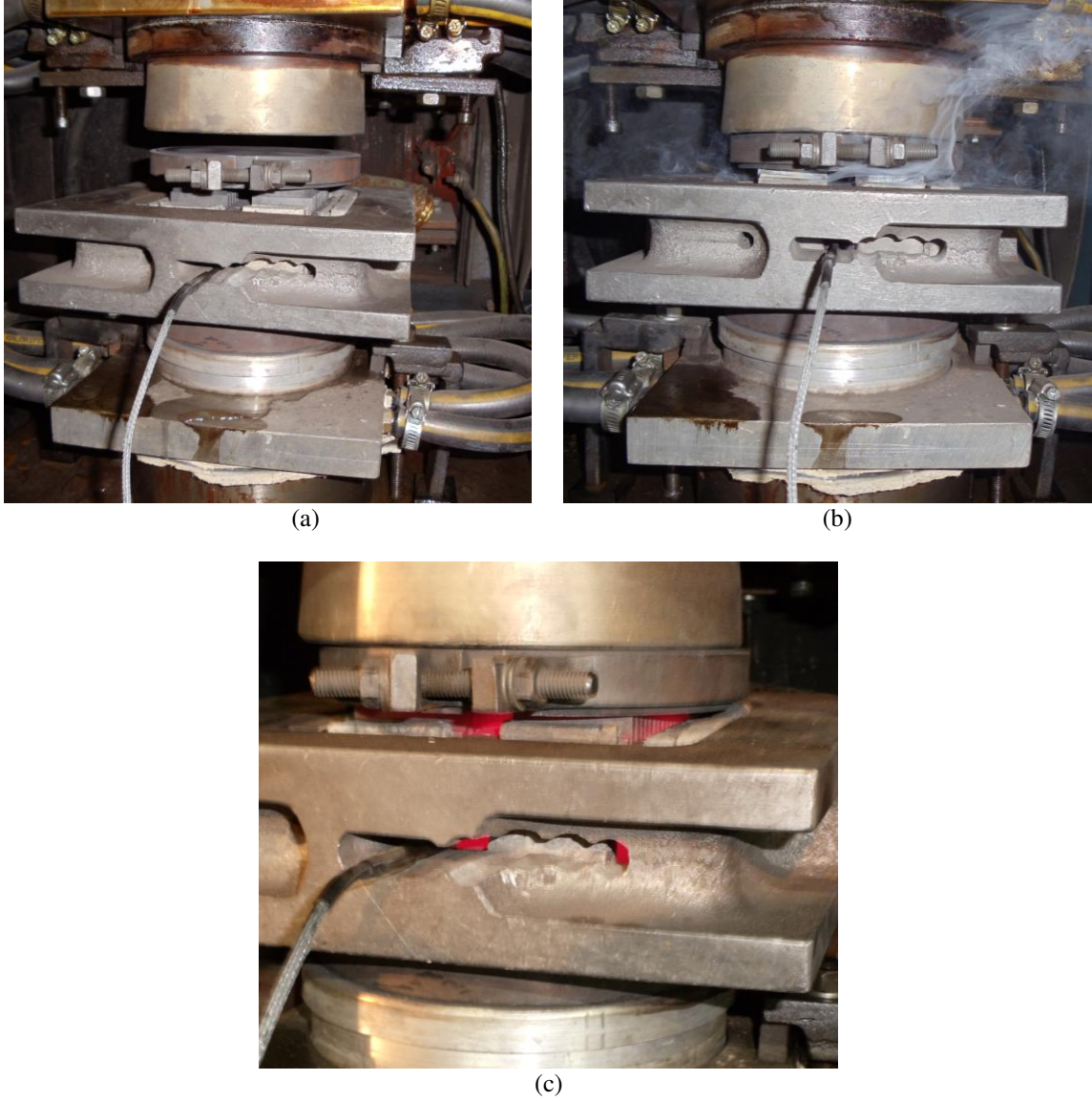
Şekil 10.6. Kalıbın sıcak prese yerleştirilmesi (a) ve sıcak presleme işlemi (b ve c)
