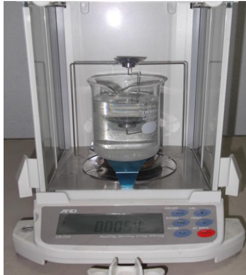
Şekil 10.9. Yoğunluk ölçümünde kullanılan yoğunluk kitli hassas terazi (AND GR-200)
