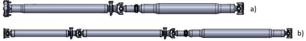
Şekil 1.2. Hafif ticari araç (HTA) kardan mili çeşitleri a) İki parçalı kardan mili b) Üç parçalı kardan mili
