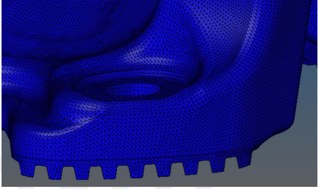
Şekil 4.14. Hafifletilmiş çatallı flanşa ait kritik bölgedeki mesh yapısı
