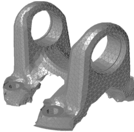
Şekil 4.9. Topoloji optimizasyonu ile %50 hacim azalması
