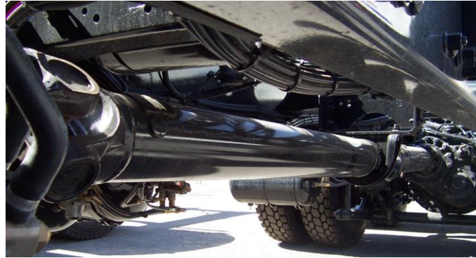
Şekil 2.1. Ağır ticari araç kardan mili bağlantı şekli [13]
