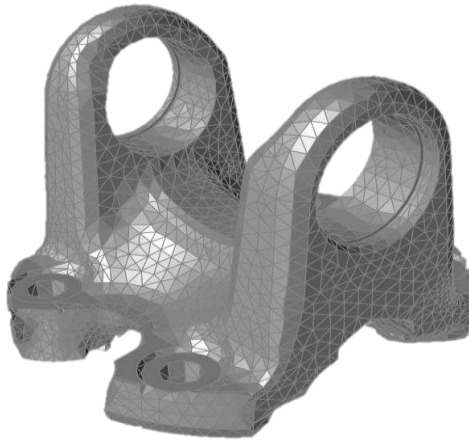
Şekil 4.11. Topoloji optimizasyonu ile %30 hacim azalması
