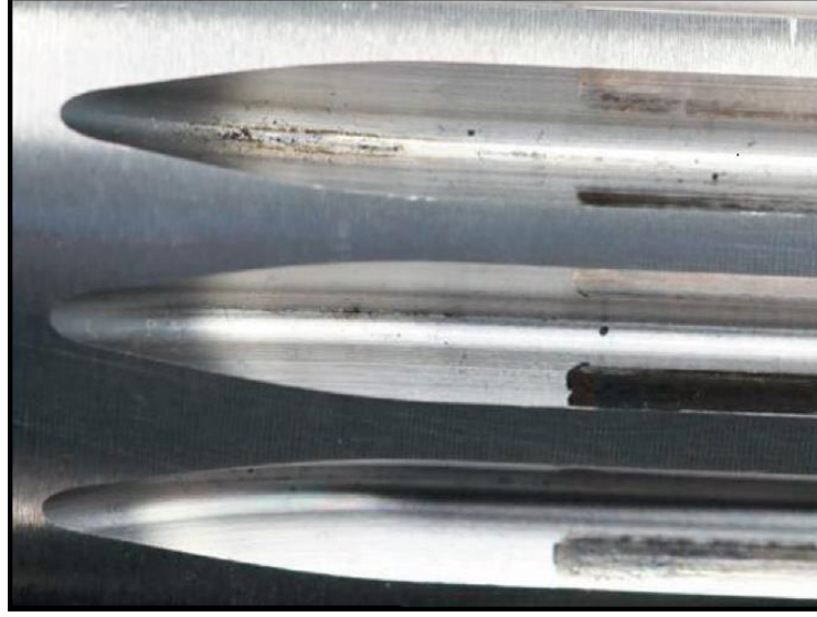
Şekil 3.9. Dişlerde oluşan aşınma örneği [21]
