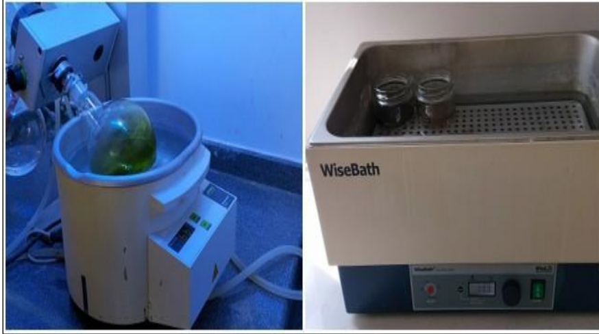
Resim 3.14. Evaporatör ve su havuzu ile ekstraksiyon işlemi
