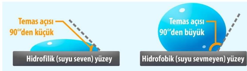
Şekil 3.6. Hidrofobik ve hidrofilik yüzeyler
