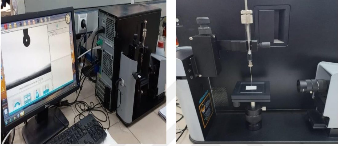
Şekil 3.7. Temas açısı cihazı; Membranın yüzeyinde oluşan damlacığın görüntüsü
