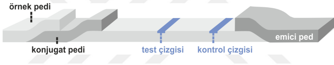
Şekil 2.2. Yanal akış test şeridinin tipik konfigürasyonu (50)
