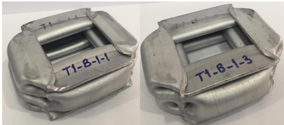
Şekil 3.15. 6063-T6-E-0-0 tüplerin eksenel ezme deneyi sonrası deformasyon görünümleri
