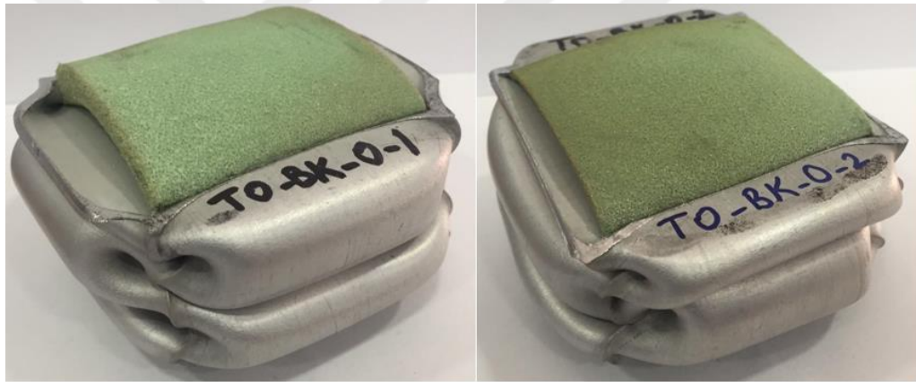
Şekil 3.7. 6063-T0-0-K-0 tüplerin eksenel ezme deneyi sonrası deformasyon görünümü
