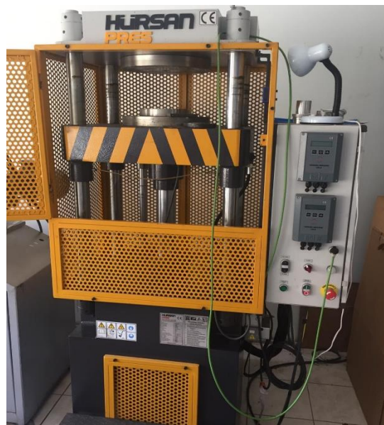
Şekil 2.13. Eksenel ezme deneyinde kullanılan hidrolik pres
