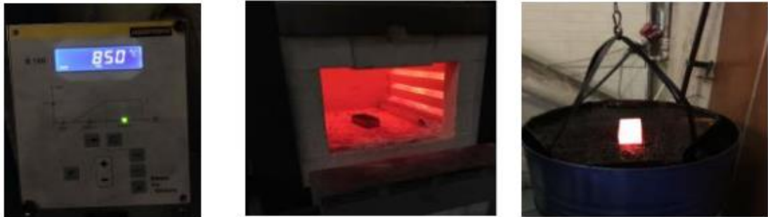
Şekil 2.2. Soğuk iş takım çeliği ısıtma işlem süreci
