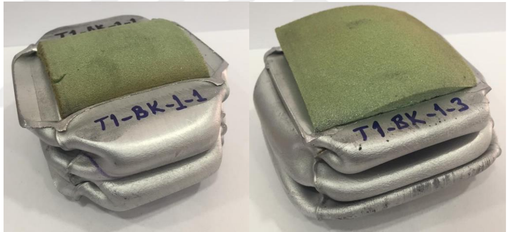
Şekil 3.19. 6063-T6-E-K-0 tüplerin eksenel ezme deneyi sonrası deformasyon görünümü
