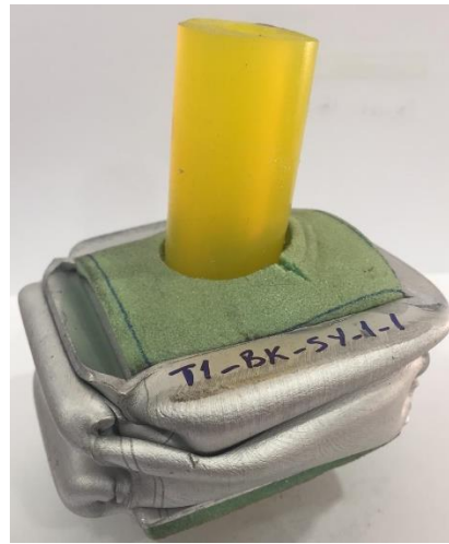
Şekil 3.25. 6063-T6-E-K-1 tüplerin eksenel ezme deneyi sonrası deformasyon görünüğü
