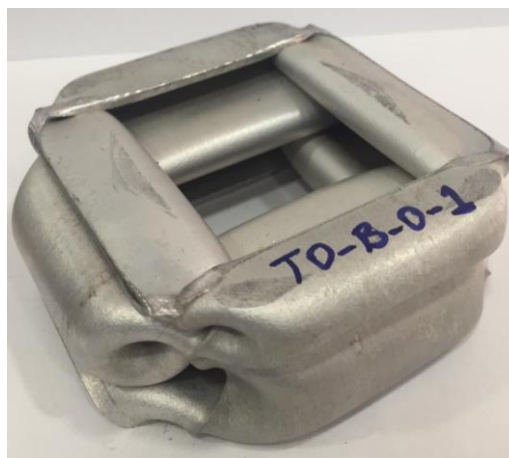
Şekil 3.3. 6063-T0-0-0-0 tüpün aksel el ezme deneyi sonrası deformasyon görünümü
