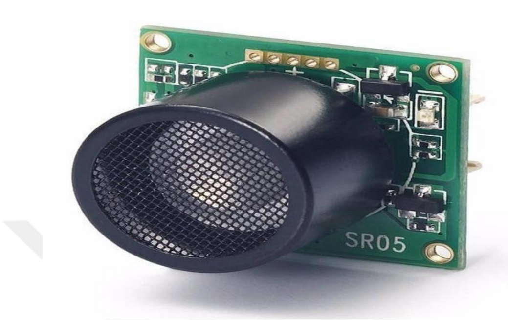
Şekil 2.1.11: Aşağıya Doğru Ultrasonik Engelden Kaçınma Sensörü
