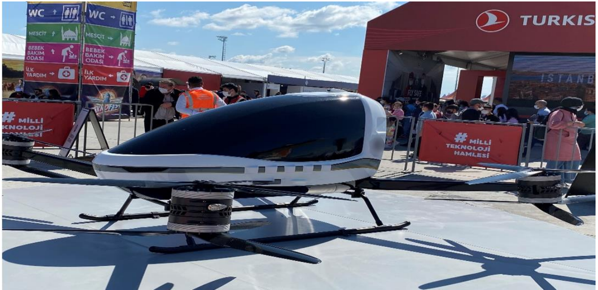
Şekil 1.4.1: Ht 448 Modüllü Kargo Taşıma Dronu
