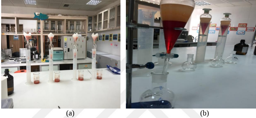
Şekil 3.8. a) Ayırma hunisi ile süzme; b) Faz ayrımının gerçekleşmesi
