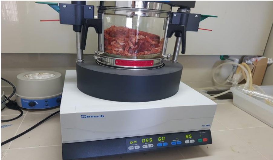
Şekil 3.3. Karides işleme artıklarının akışkan yataklı kurutucuda kurutulması
