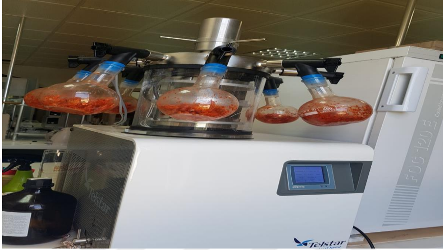
Şekil 3.4. Karides işleme artıklarının dondurarak kurutucuda kurutulması
