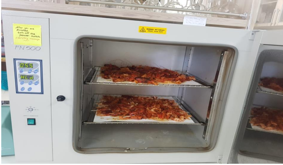
Şekil 3.2. Karides işleme artıklarının etüvde kurutulması
