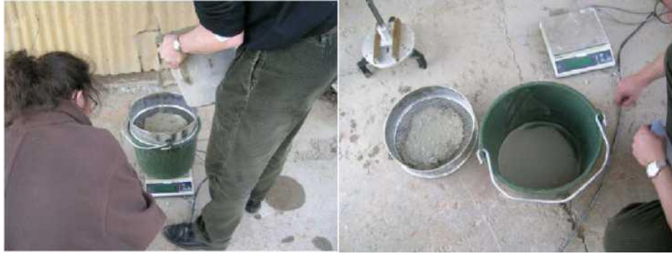
Şekil 2.10 Elek ayırma testi ve aparatları (EFNARC, 2005)
