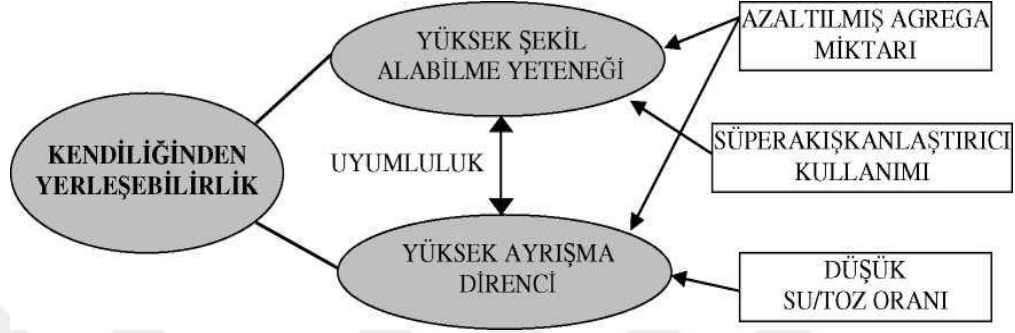
Şekil 2.3 Kendiliğinden yerleşebilirliğin başarılması için temel yöntem (Okamura ve Ozawa, 1995)
