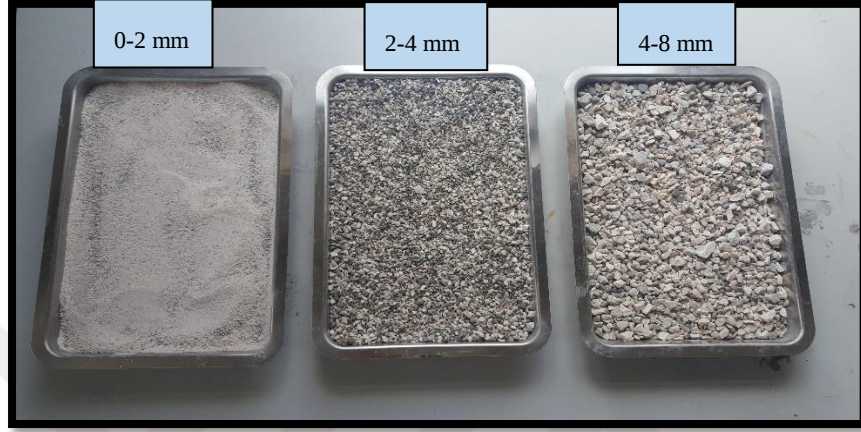
Şekil 3.1. Lifli KYB üretiminde kullanılan agregalar
