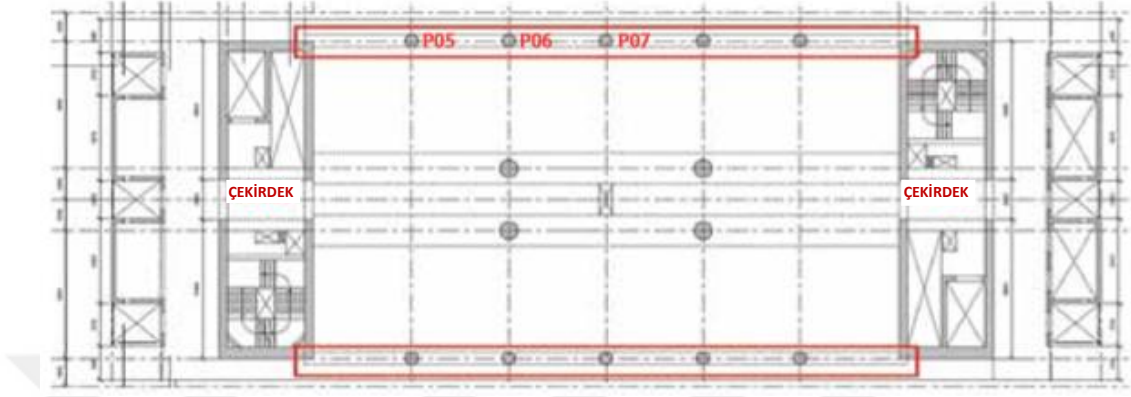
Şekil 3.64 Allianz Tower'ın 23. ve 49. katlarındaki "belt-truss" yerlerini gösterir şekil (F. Mola ve diğer., 2017)
