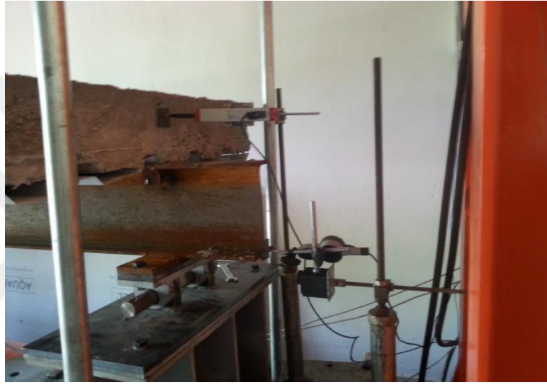
Şekil 3.29. Tüm numuneler için uzama ve ksalma ölçüm cihazları
