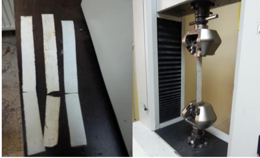
Şekil 3.11. Trapez sac çekme deneyinden bazı görüntüler
