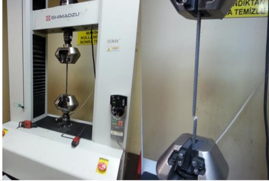
Şekil 3.7. Donatı çekme deneyi
