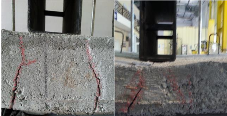
Şekil 3.36. DN2-1S-D120 numuneye ait ön ve arka çatlak görüşleri
