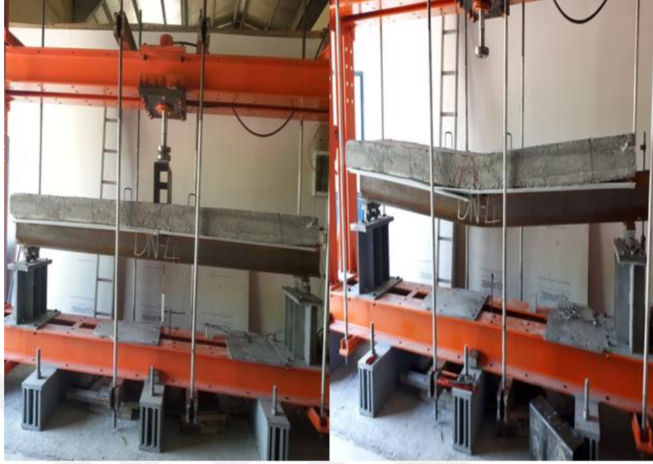
Şekil 3.47. DN4-1S-D150 numuneye ait öncesi ve sonrası resimler
