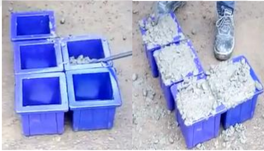
Şekil 3.4. Küp numunelerinin hazırlanışı
