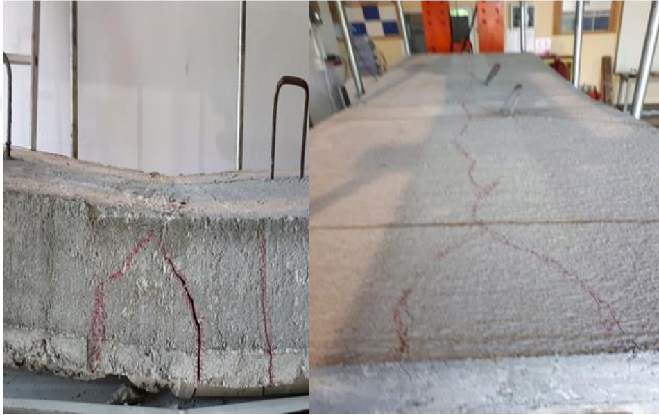
Şekil 3.54. DN5-2S-D120 numuneye ait ön ve üst çatlak görünüşleri
