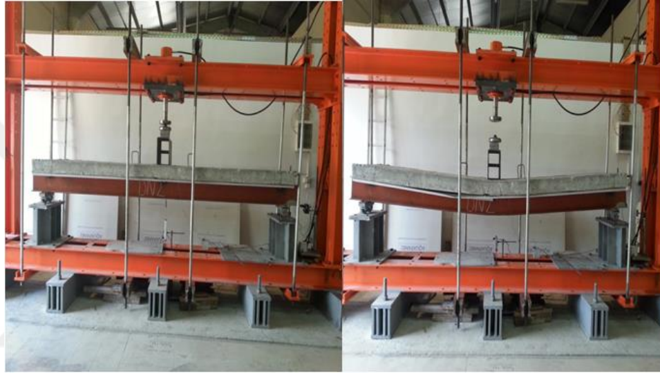
Şekil 3.35. DN2-1S-D120 numuneye ait öncesi ve sonrası resimler
