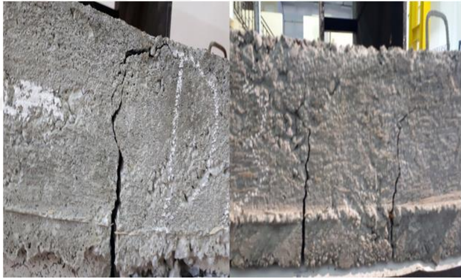
Şekil 3.31. DN1-1N-D120 numuneye ait ön ve arka çatlak görünüşleri
