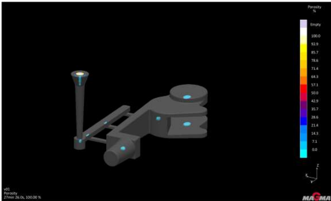
Şekil 4.12. İki numaralı parçanın farklı açıdan yolluklu porosity görüntüsü
