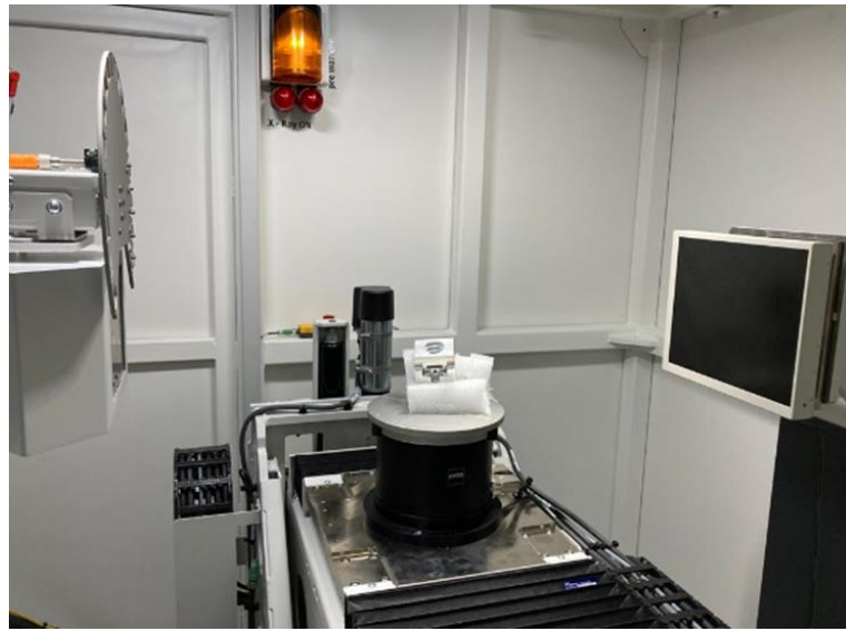
Görsel 5.10. XBT sistemi ile parçanın ölçümü için kullanılan düzen
