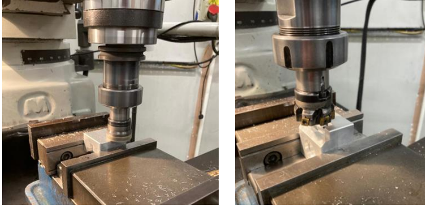
Görsel 5.2. Talaşlı imalat numunesinin üretilmesi için operasyon sırasında alınmış bir görüntü
