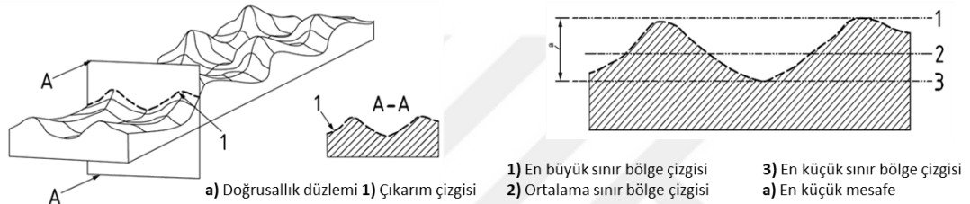
Şekil 2.2. Doğrusallık düzlemi, bu düzlem kullanılarak oluşturulan çıkarım çizgisi ve sınır bölge referans çizgileri (ISO 12780-1)
