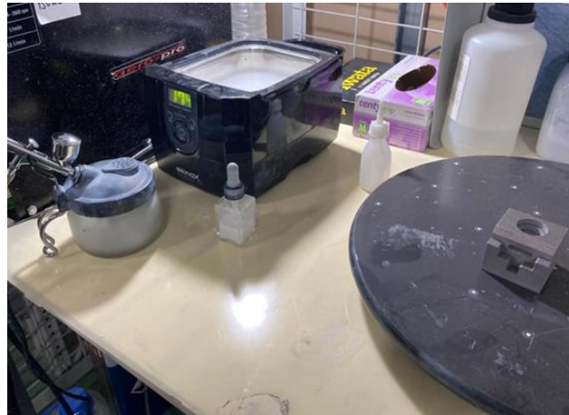
Görsel 5.7. Developer uygulaması için kullanılan \text{TiO}_2 – alkol çözeltisi ve havalı boya tabancası
