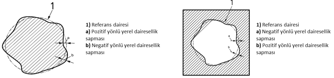
Şekil 2.8. Erkek ve dişi dairesel unsurlar için yerel dairesellik sapmaları (ISO 12181-1)
