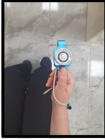
Şekil 3.6: Pinç kuvveti ölçümü
