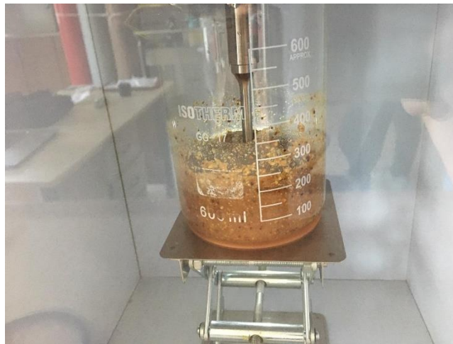
Resim 3.7 Ultrason cihazı prob yerleşimi .
