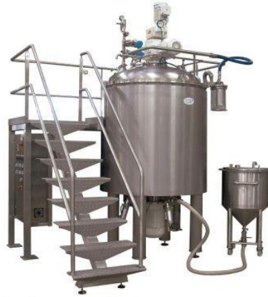
Resim 2.3 Vakum altında pişirme ünitesi (İnt. Kyn. 3).
