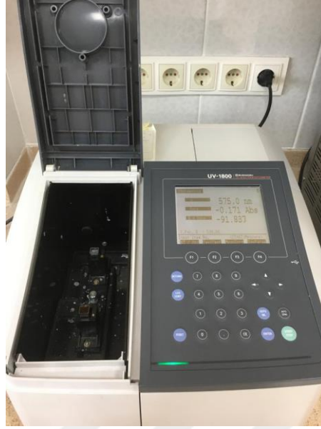
Resim 3.24 575 nm’de örneklerin Spektrofotometre ile okunması.
