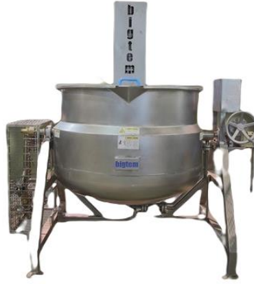
Resim 2.2 Açık kazan pişirme ünitesi (İnt. Kyn. 2).
