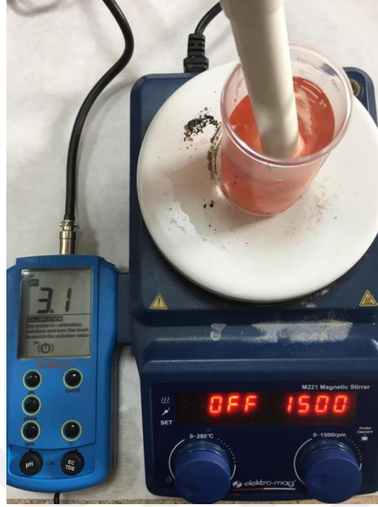
Resim 3.18 Pektinli vişne reçelinin pH ölçümü.
