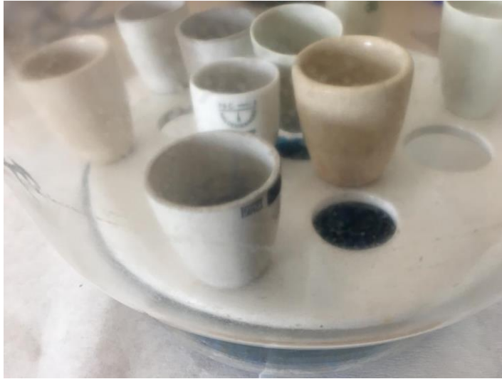
Resim 3.28 Yakma işlemi tamamlanmış örneklerin desikatörde soğutulma aşaması.
