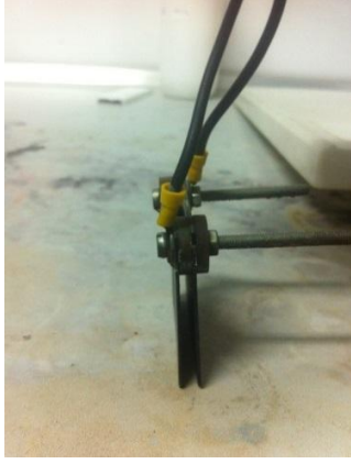
Şekil 4.4. Elmas paralel plaka elektrot
