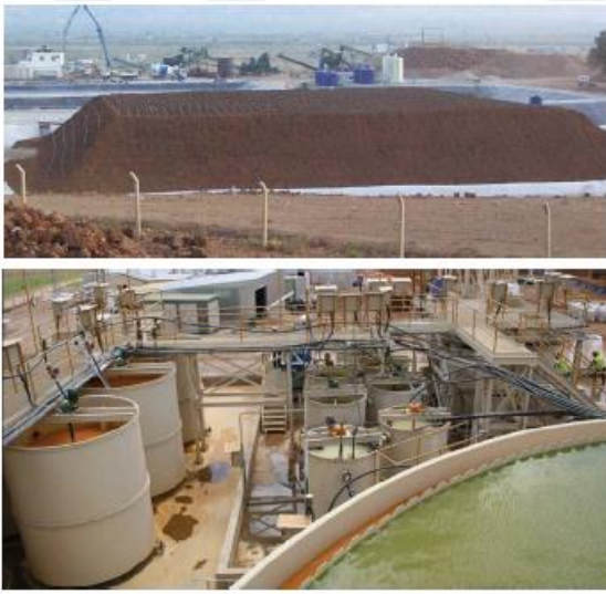
Şekil 1.7. Pilot yığın liçi uygulaması Manisa- Çaldağ a) Yığın b) Liç tankları
